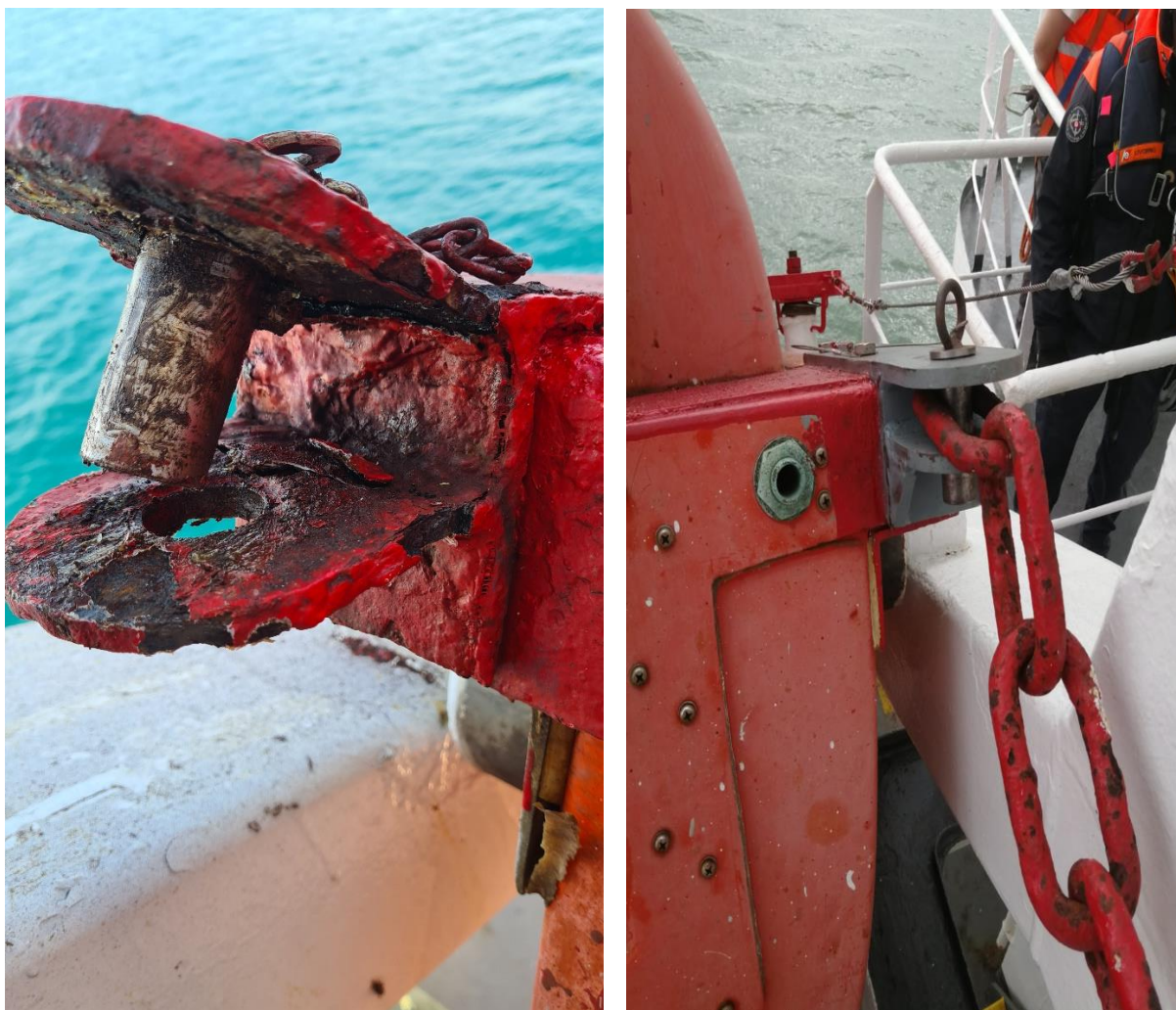
Fig. 5 – Aggancio della ritenuta a catena, prima e dopo il ripristino (fonte Capitaneria di Porto Marina di Carrara)
