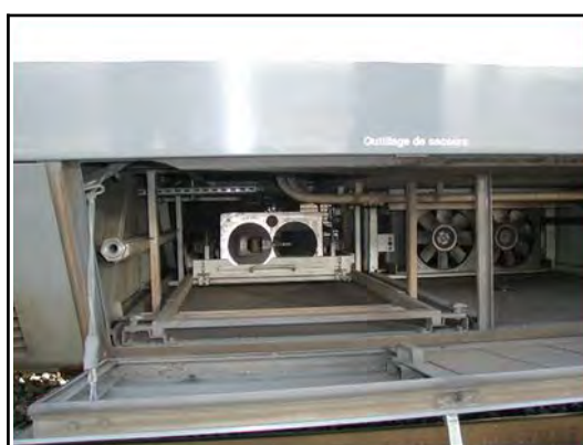
Figura 30: accoppiamenti di soccorso localizzati sul lato della motrice 380005 (a sinistra) e della motrice 380006 (a destra) (foto SNCF Voyageurs)
