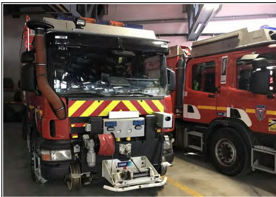
Figura 8: veicolo strada-rotaia del SDIS (foto BEA-TT)
