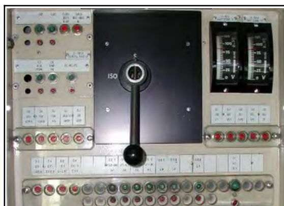
Figura 16: particolare della chiave Z (SEC) (foto SNCF Voyageurs)
