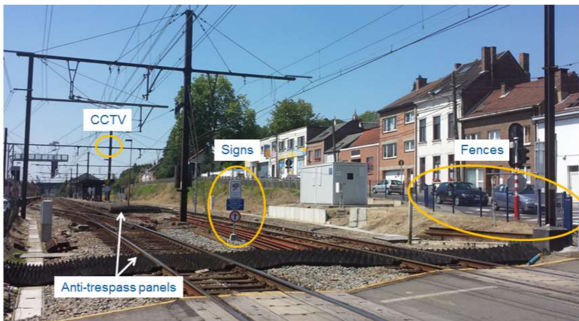
Foto n. 10 - Tipologia di dissuasori di attraversamento binari sperimentati in Belgio
