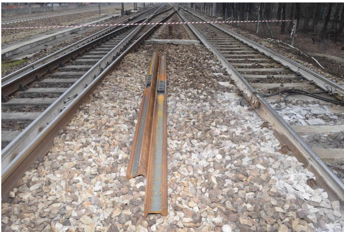
Figura 72 – Giunti isolanti incollati da porre in opera in prossimità del km 13+400 (fonte: Polizia Scientifica)
