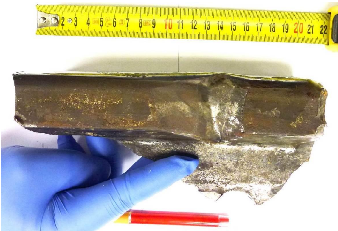
Figura 52 - Spezzone della rotaia del GII distaccata, vista del fungo dal lato interno del binario. (fonte: Digifema)
