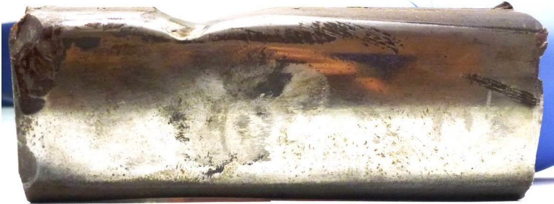
Figura 61 - Spezzone della rotaia del GII distaccata, vista del fungo dal lato superiore. Evidenza dei segni di martellamento che risaltano a seguito della pulitura (fonte: Digifema)
