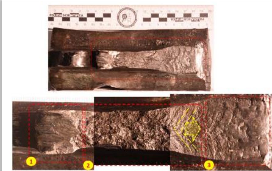
Figura 45 - Macrofrattografie della superficie dello spezzone di rotalia, visto dal basso (fonte: Relazione di Consulenza Tecnica per il Pubblico Ministero per la Determinazione della Dinamica del Deragliament del treno R 10452 (Cremona - Milano Porta Garibaldi), 28.02.2019)
