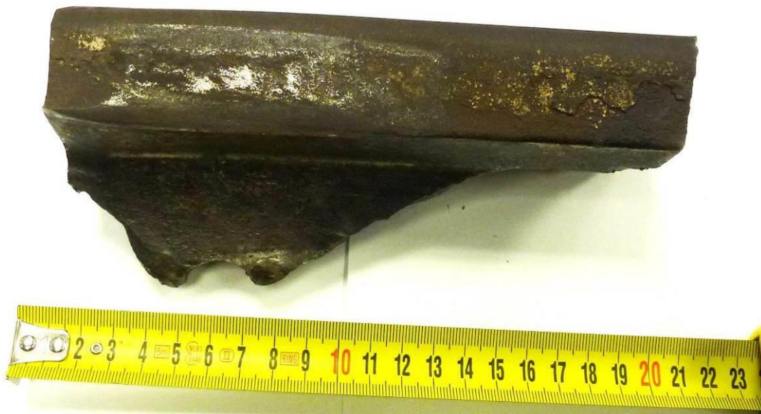
Figura 56 - Spezzone della rotaia del GII distaccata, vista del fungo dal lato esterno del binario (fonte: Digifema)
