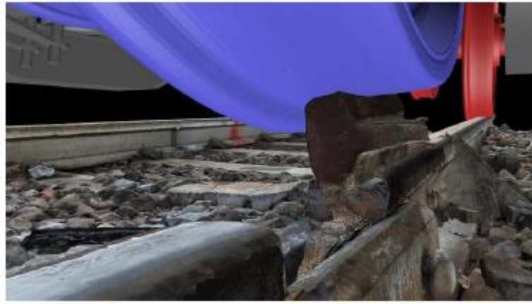
Figura 67 – Posizione di massima sopraelevazione della ruota sviata (fonte: Relazione di Consulenza Tecnica per il Pubblico Ministero per la Determinazione della Dinamica del Deragliament del treno R 10452 (Cremona - Milano Porta Garibaldi) , 28.02.2019)
