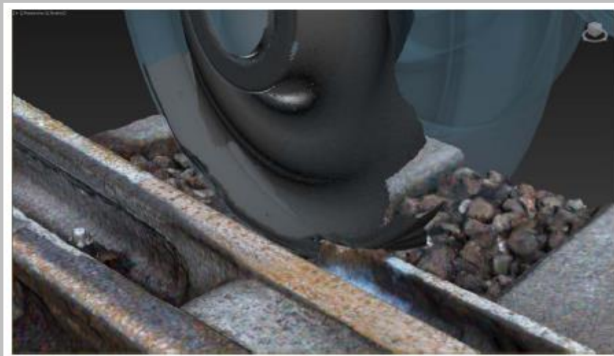
Figura 71 – Risultato della verifica di compatibilità morfologica tra i segni d’urto riscontrati sul deviatoio 6b e la sala montata posteriore del carrello anteriore della carrozza 3 (fonte: Relazione di Consulenza Tecnica per il Pubblico Ministero per la Determinazione della Dinamica del Deragliament del treno R 10452 (Cremona - Milano Porta Garibaldi), 28.02.2019)
