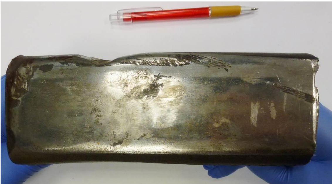
Figura 62 - Spezzone della rotaia del GII distaccata, vista del fungo dal lato superiore. Evidenza dei segni di martellamento e di rotolamento di bordino sul piano di rotolamento. (fonte: Digifema)
