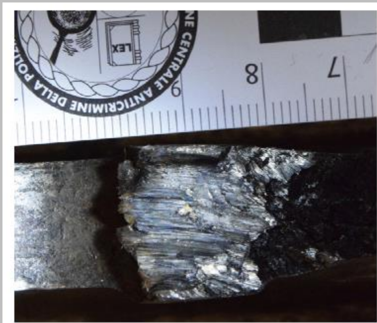
Figura 46 - Particolare ingrandito della zona 1 di Figura 45 (fonte: Relazione di Consulenza Tecnica per il Pubblico Ministero per la Determinazione della Dinamica del Deragliament del treno R 10452 (Cremona - Milano Porta Garibaldi), 28.02.2019)
