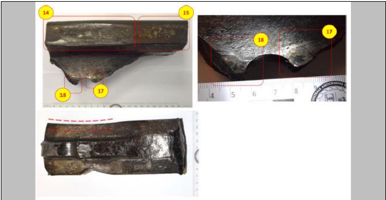
Figura 65 – Vista laterale dello spezzone di rotaia, lato esterno al binario (fonte: Relazione di Consulenza Tecnica per il Pubblico Ministero per la Determinazione della Dinamica del Deragliament del treno R 10452 (Cremona - Milano Porta Garibaldi), 28.02.2019)
