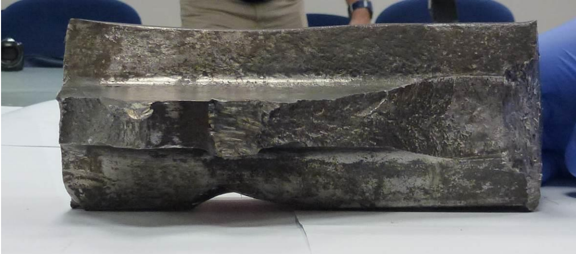
Figura 44 - Spezzone della rotaia del GII distaccata, vista dal basso, superficie della frattura (fonte: Digifema)
