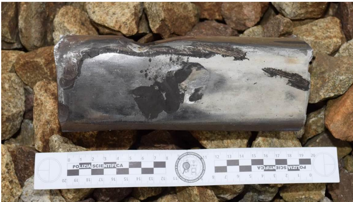
Figura 60 - Spezzione della rotaia del GII distaccata, vista del fungo dal lato superiore nella posizione del ritrovamento (fonte: Polizia Scientifica)
