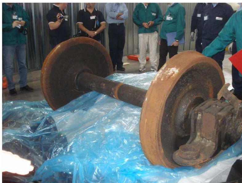
Assile 98331 frattura il 16/05/2012 c/o Lucchini - Fonte Commissione Ministeriale di Indagine
