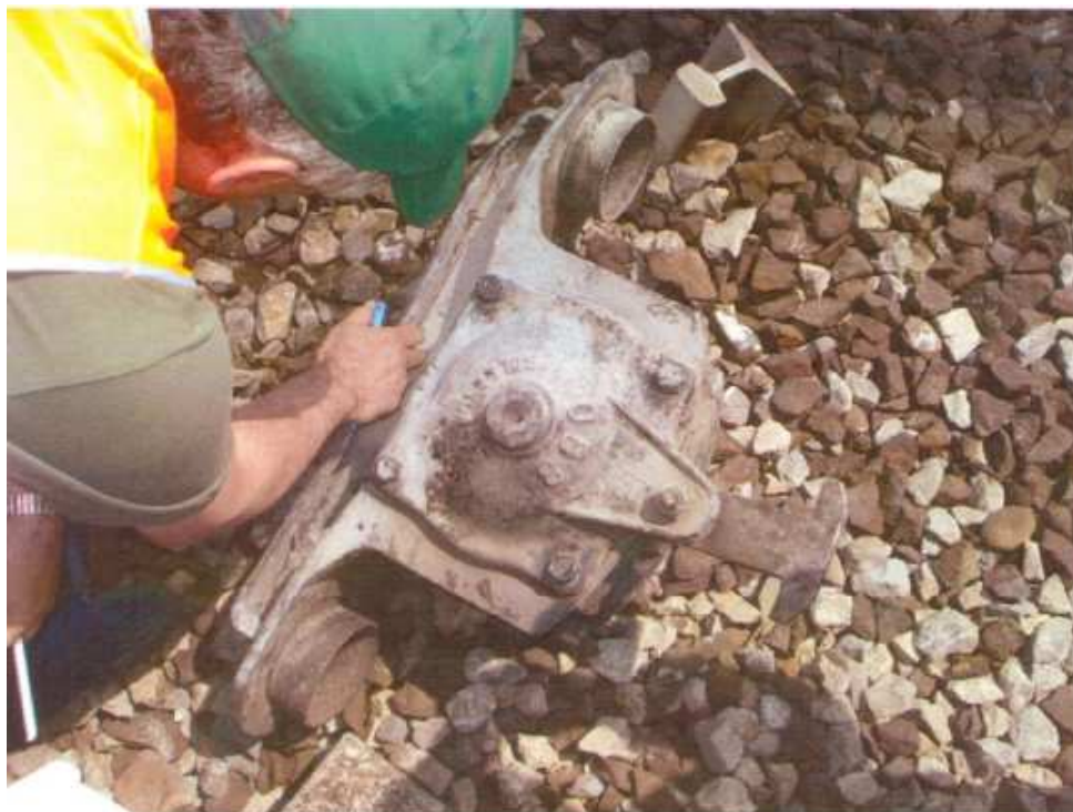
Inizio delle operazioni di apertura del contenitore della boccola - Fonte Commissione Ministeriale di Indagine
