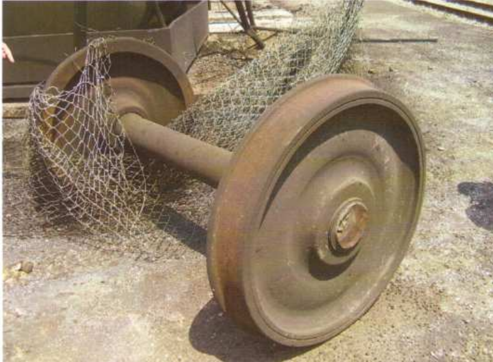
Sala montata 98331 con assile tranciato - Fonte Commissione Ministeriale di Indagine
