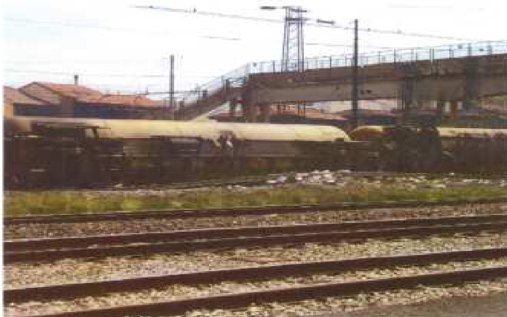
Terzo e quarto carro cisterna ribaltati – Fonte Commissione Ministeriale di Indagine
