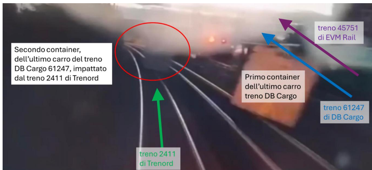
Figura 12 – Vista da telecamera frontale della cabina di guida del treno n. 2411; sono visibili le sagome dei due container caduti sui binari (fonte immagine: Relazione di inchiesta Trenord; elaborazione: Commissione di indagine).
