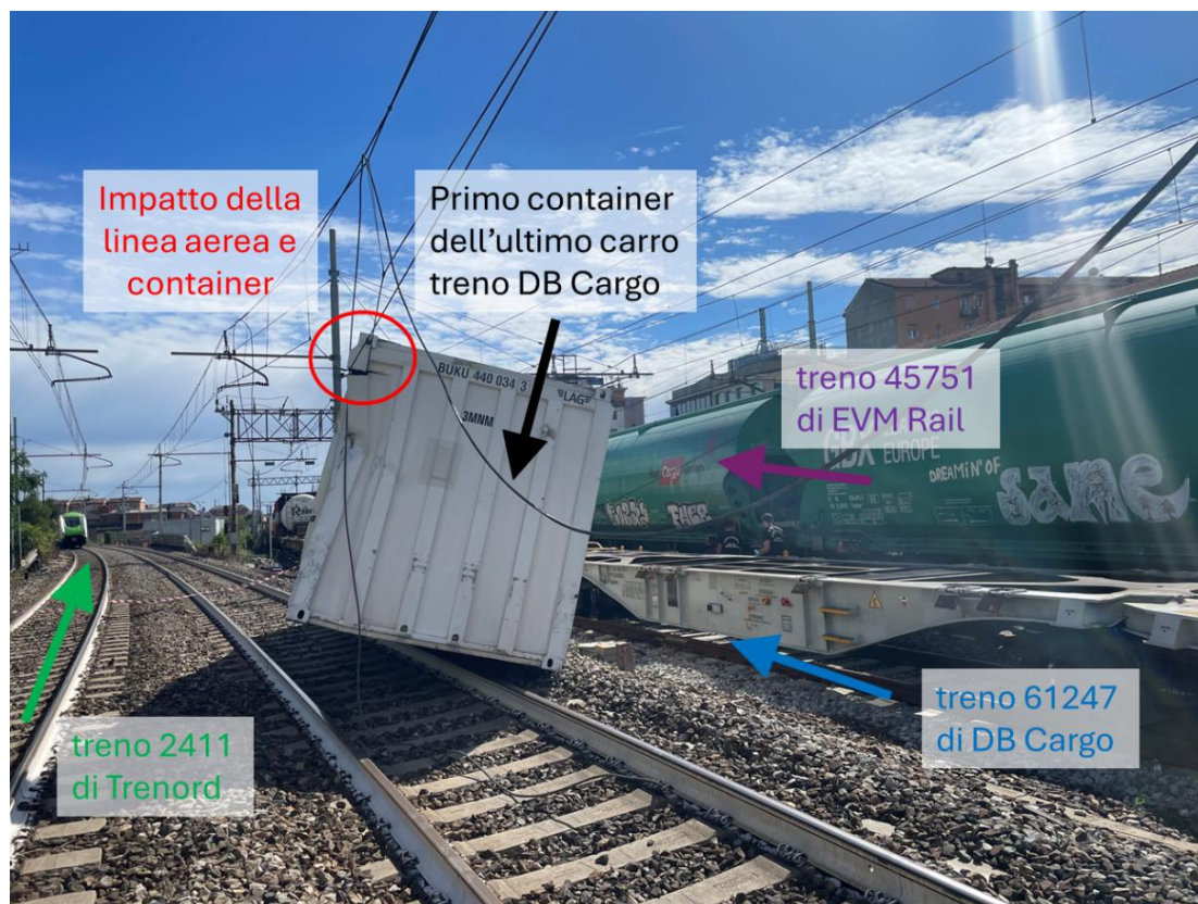
Figura 8 – Dettaglio del primo container trasportato sull'ultimo carro del treno n. 61247 di DB Cargo. A seguito della collisione il container ha urtato la linea aerea rimanendo da un lato appoggiato sulla massicciata del binario pari e dall'altro sospeso alla linea aerea (fonte immagine: Commissione di indagine; elaborazione: Commissione di indagine).
