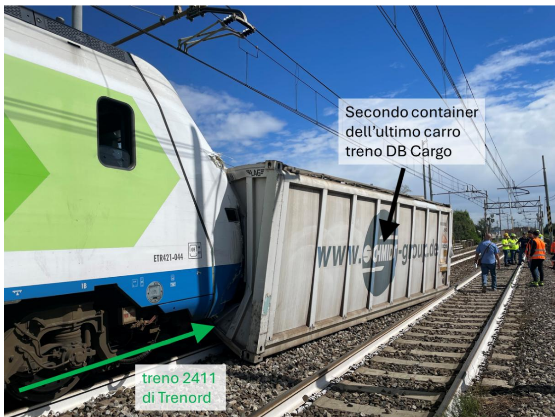
Figura 11 – Collisione tra il treno n. 2411 di Trenord e il secondo container trasportato sull'ultimo carro del treno n. 61247 di DB Cargo (fonte immagine: Commissione di indagine; elaborazione: Commissione di indagine).
