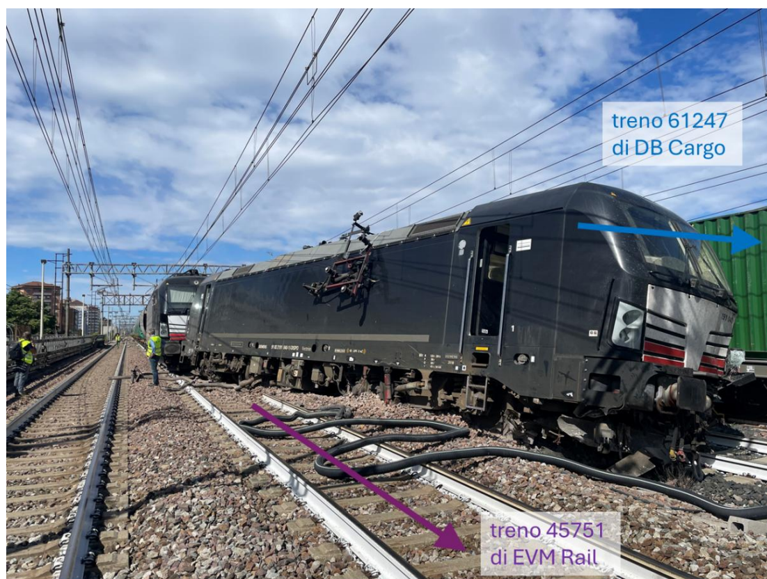
Figura 9 – Dettaglio della locomotiva di testa del treno n. 45751 di EVM Rail che ha urtato l'ultimo carro del treno n. 61247 di DB Cargo. A seguito di questa prima collisione si è verificato lo svio della locomotiva (fonte immagine: Commissione di indagine; elaborazione: Commissione di indagine).
