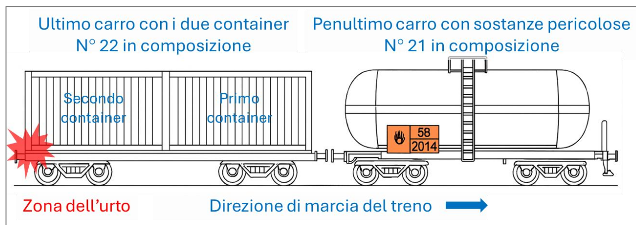
Figura 23 – Schema esemplificativo degli ultimi due carri del treno n. 61247 di DB Cargo Italia (elaborazione immagine: Commissione di indagine).
