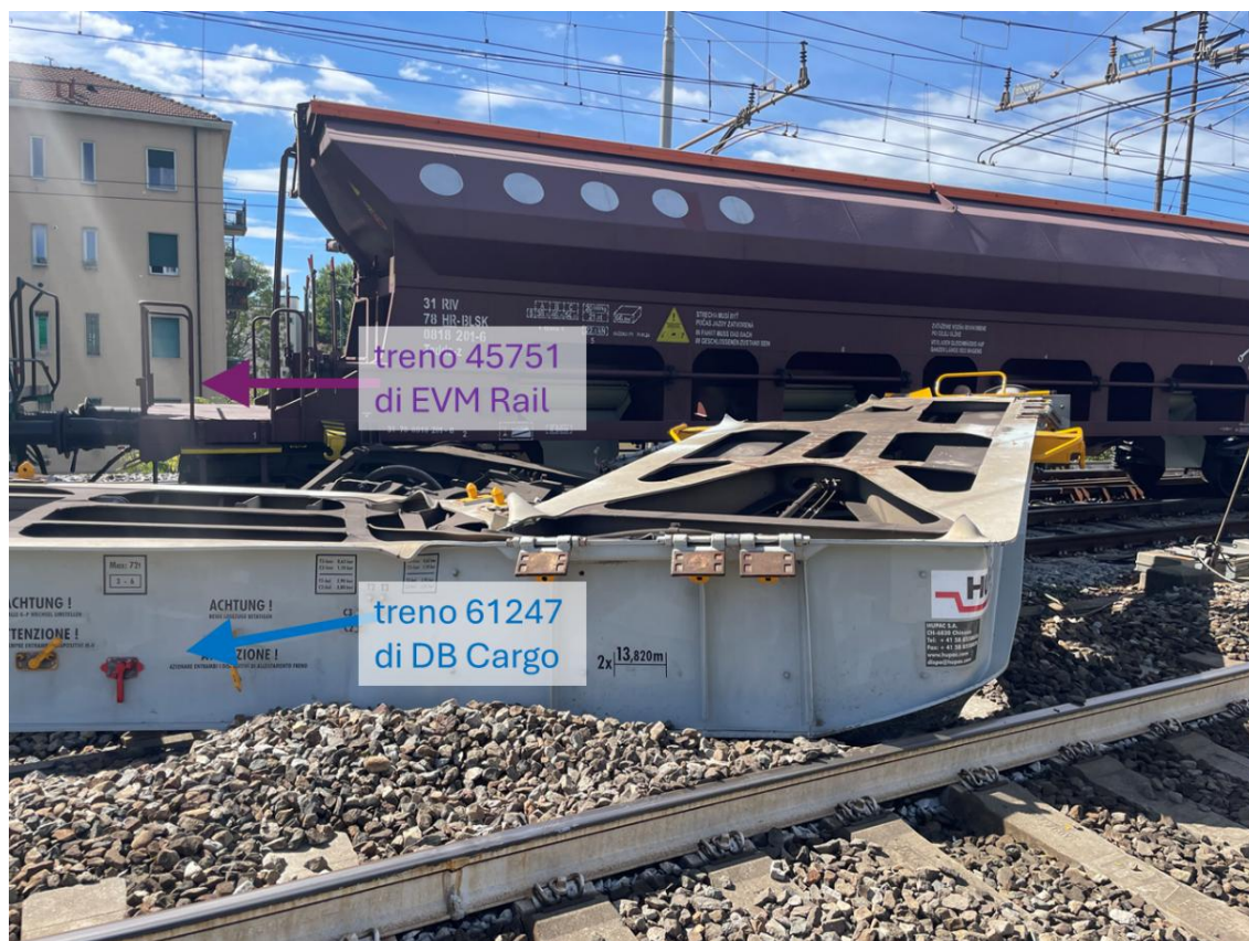
Figura 7 – Dettaglio dell'ultimo carro del treno n. 61247 di DB Cargo che trasportava due container a seguito della collisione; vista laterale in cui si evince il danno del carro e dei relativi carrelli (fonte immagine: Commissione di indagine; elaborazione: Commissione di indagine).
