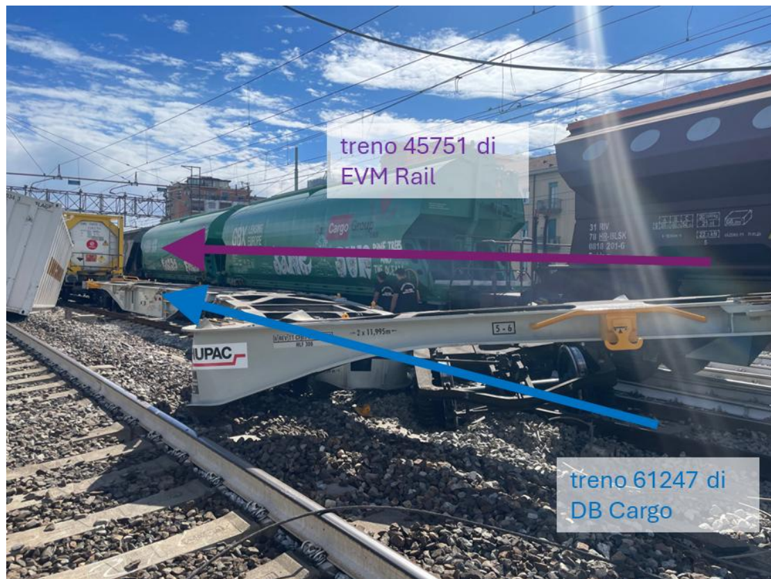
Figura 6 – Dettaglio dell'ultimo carro del treno n. 61247 di DB Cargo che trasportava due container a seguito della collisione; vista posteriore in cui si evince la presenza del primo container sulla massicciata del binario pari della Linea Viaggiatori (fonte immagine: Commissione di indagine; elaborazione: Commissione di indagine).
