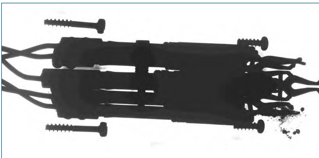
Figura 2 - Spina-presa del connettore di alimentazione di un semirimorchio refrigerato (Fonte: report del MAIB)
