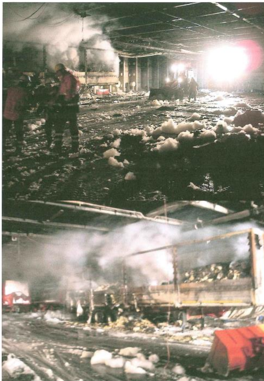
Figura 1- Il garage della ro-pax ATHARA dopo lo spegnimento dell'incendio (Fonte: inchiesta formale di Direzione marittima di Genova)
