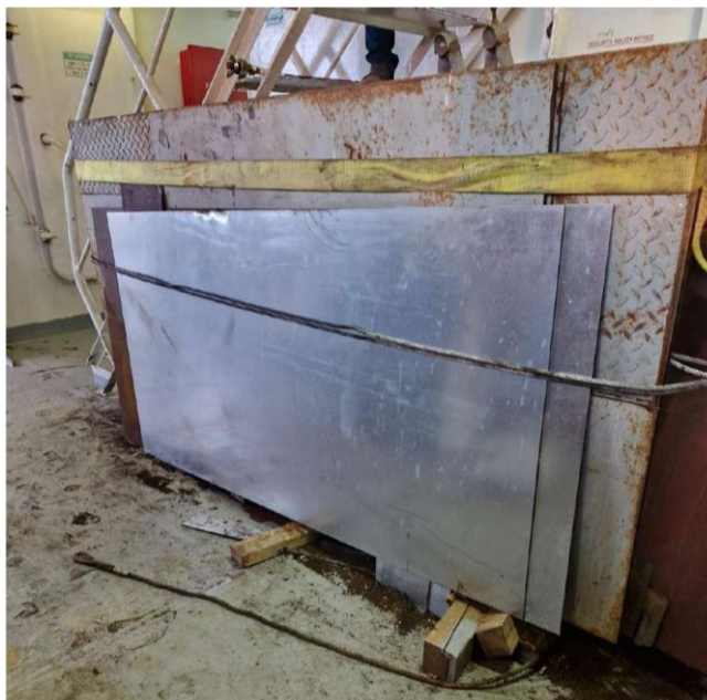
Fig. 8 – Posizione del pacco di lamiera rizzate subito dopo l'evento (Fonte Ignazio Messina & C SpA)
