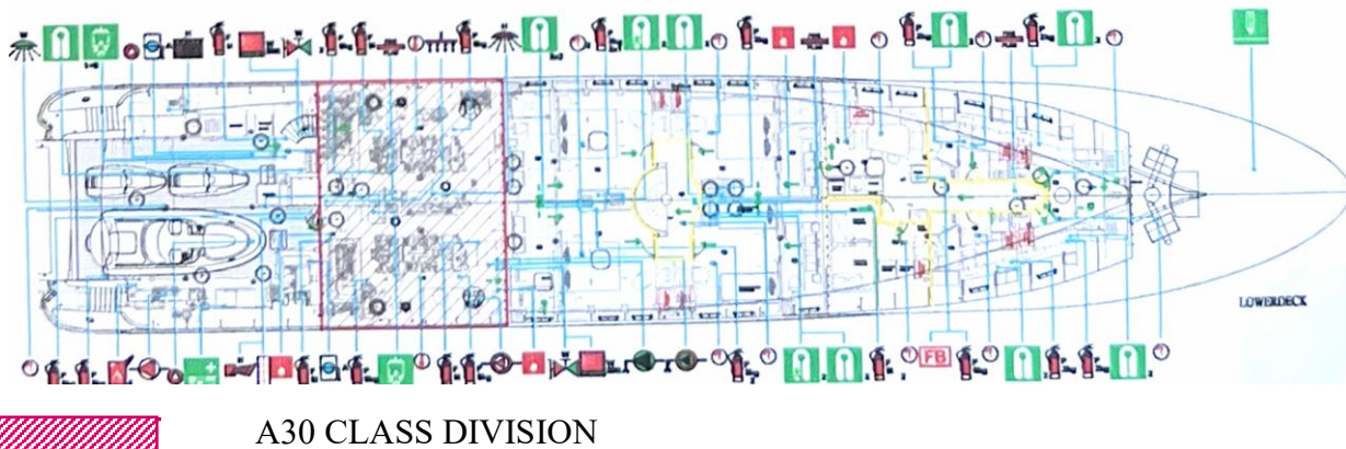
Figura 6 - Indicazione compartimentazione e dotazioni antincendio
