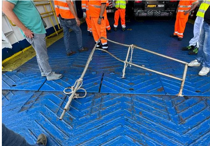
Figura n. 6 – Foto scattata dalla Capitaneria di Porto di Livorno una volta recuperata la battagliola rimasta incastrata alla prua della M/N “SHARDEN”
