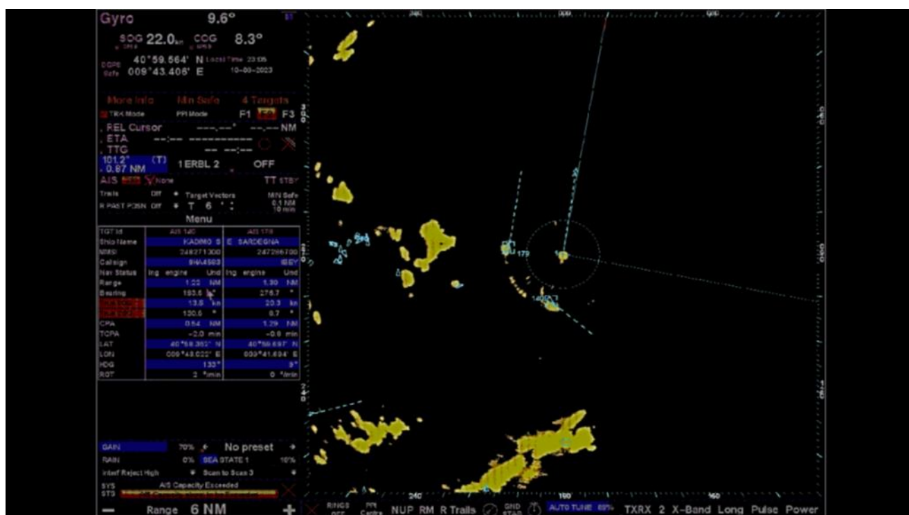
Figura n. 11 – schermata VDR delle ore 21:05:08 UTC, momento in cui il M/P “ALEMAX II” fa il suo ingresso nel cerchio di rilevamento di eventuali bersagli settato con un raggio di ampiezza di 0,87 Nm - Nautical Miles.
