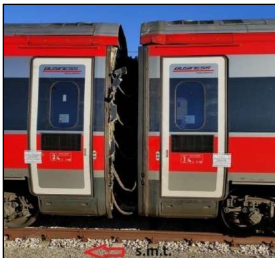
8.5 LdS Faenza – elementi danneggiati (fonte Ufficio)
