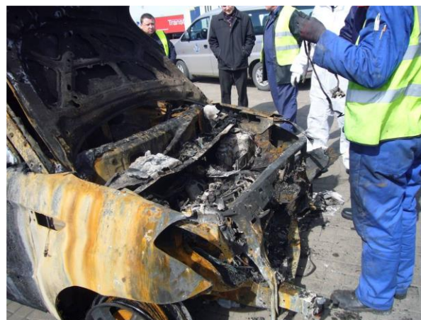
La foto mostra il cofano di un'auto da cui si ritiene si sia originato l'incendio della Victoria Seaways (foto tratta dal report dell'autorità lituana)
