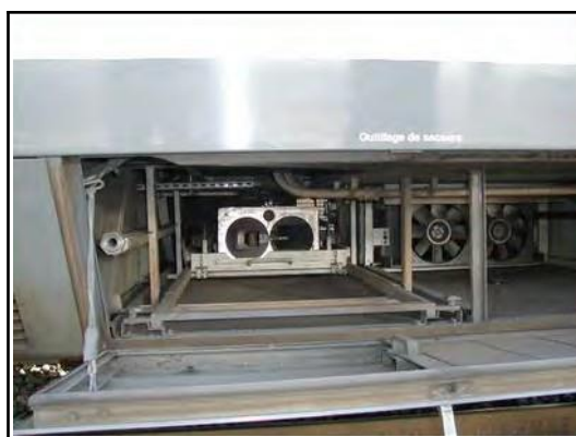
Figura 30: accoppiamenti di soccorso localizzati sul lato della motrice 380005 (a sinistra) e della motrice 380006 (a destra) (foto SNCF Voyageurs)
