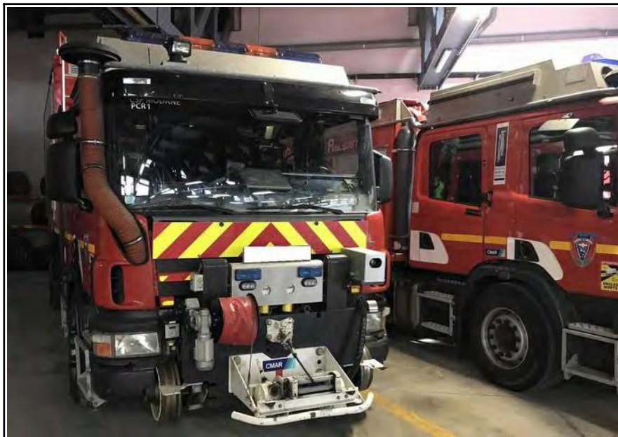
Figura 8: veicolo strada-rotaia del SDIS (foto BEA-TT)
