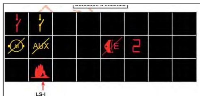
Figura 27: esempio di visualizzazione sul BSI in caso di allarme LS-I (fonte SNCF Voyageurs)
