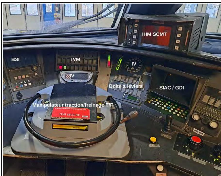
*Figure 13 : vue détaillée du pupitre de la motrice 380 005 (photo BEA-TT)*
