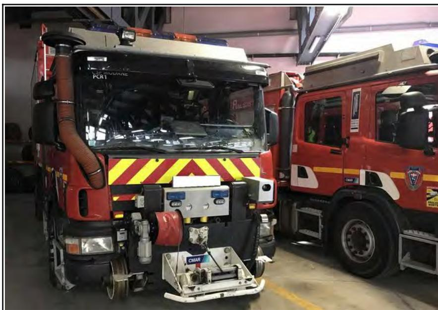
*Figure 8 : véhicule rail-route du SDIS (photo BEA-TT)*
