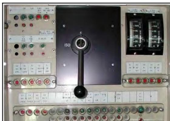
**Figure 16 : vue de la clé Z (SEC) (photo SNCF Voyageurs)**
