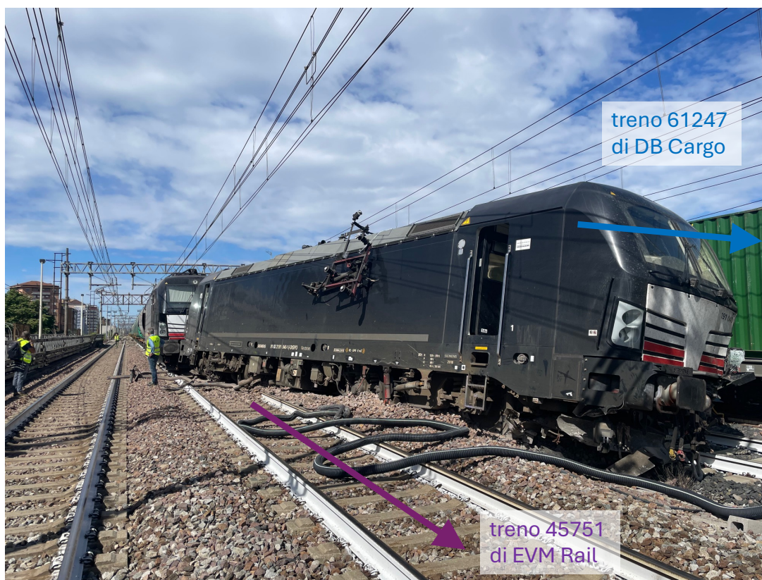
Figura 9 – Dettaglio della locomotiva di testa del treno 45751 di EVM Rail che ha urtato l'ultimo carro del treno 61247 di DB Cargo. A seguito della collisione si è verificato lo svio della locomotiva (fonte immagine: Commissione di indagine; elaborazione: Commissione di indagine).
