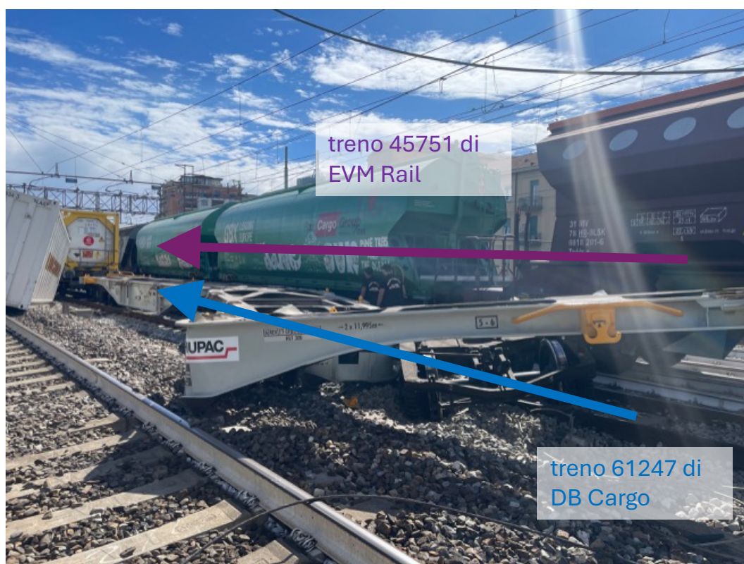
Figura 6 – Dettaglio dell'ultimo carro del treno 61247 di DB Cargo che trasportava due container a seguito della collisione; vista posteriore in cui si evince la presenza del primo container sulla massicciata del binario pari (fonte immagine: Commissione di indagine; elaborazione: Commissione di indagine).
