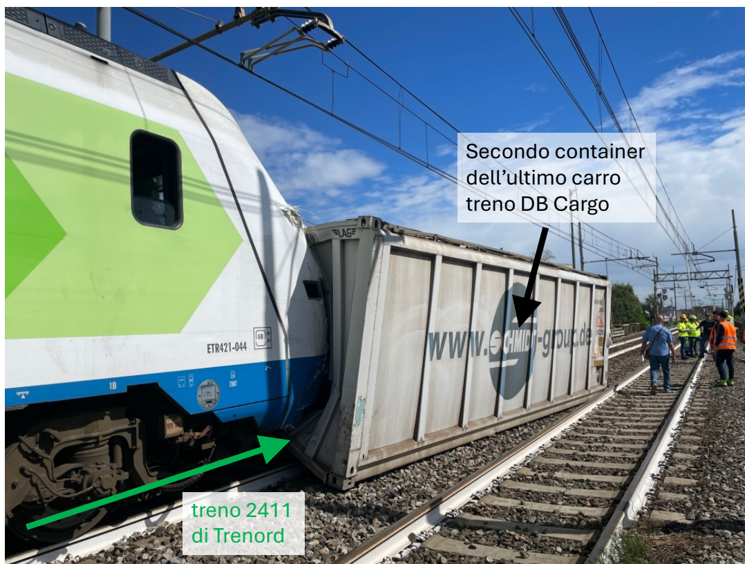
Figura 11 – Collisione tra il treno 2411 di Trenord e il secondo container trasportato sull'ultimo carro del treno 61247 di DB Cargo (fonte immagine: Commissione di indagine; elaborazione: Commissione di indagine).
