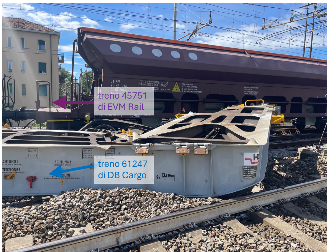
Figura 7 – Dettaglio dell'ultimo carro del treno 61247 di DB Cargo che trasportava due container a seguito della collisione; vista laterale in cui si evince il danno del carro e dei relativi carrelli (fonte immagine: Commissione di indagine; elaborazione: Commissione di indagine).
