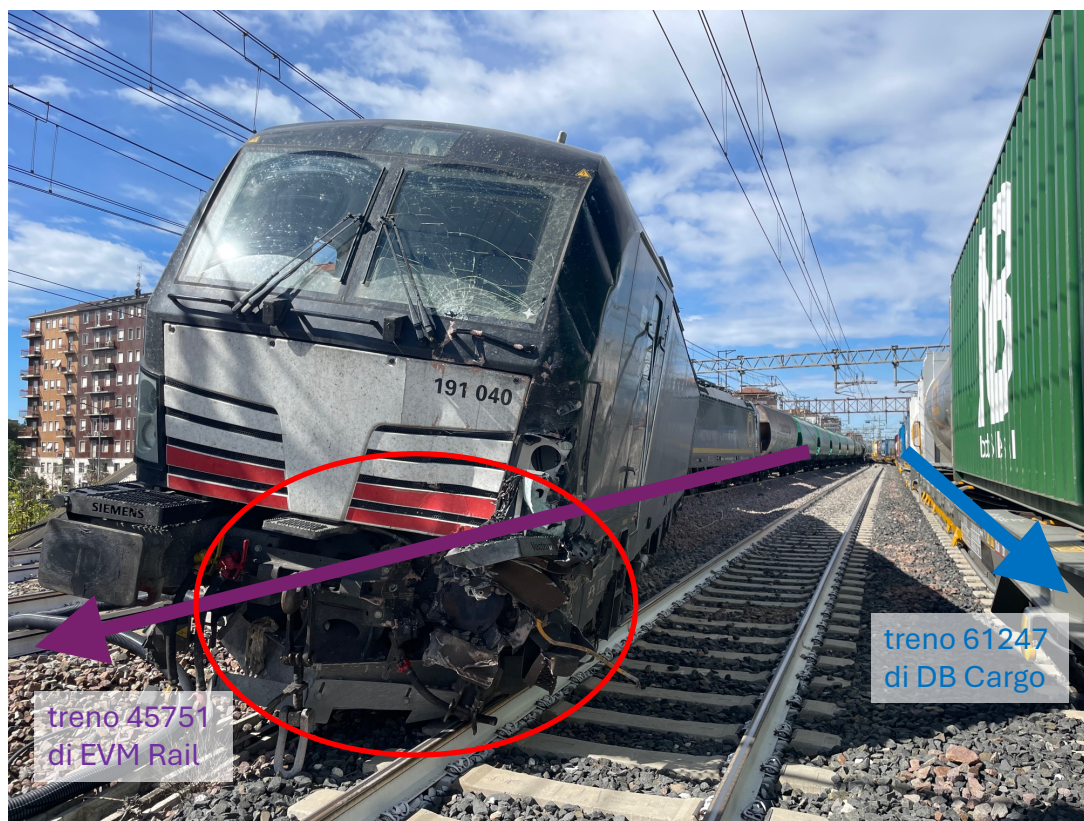
Figura 10 – Dettaglio della locomotiva di testa del treno 45751 di EVM Rail che ha urtato l'ultimo carro del treno 61247 di DB Cargo. In particolare, si evince, in rosso, la zona dell'impatto (fonte immagine: Commissione di indagine; elaborazione: Commissione di indagine).
