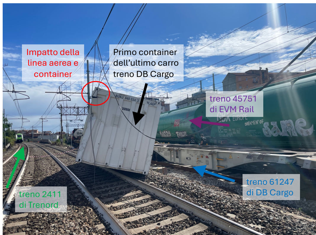
Figura 8 – Dettaglio del primo container trasportato sull'ultimo carro del treno 61247 di DB Cargo. A seguito della collisione il container ha urtato la linea aerea rimanendo da un lato appoggiato sulla massicciata del binario pari e dall'altro sospeso alla linea aerea (fonte immagine: Commissione di indagine; elaborazione: Commissione di indagine).
