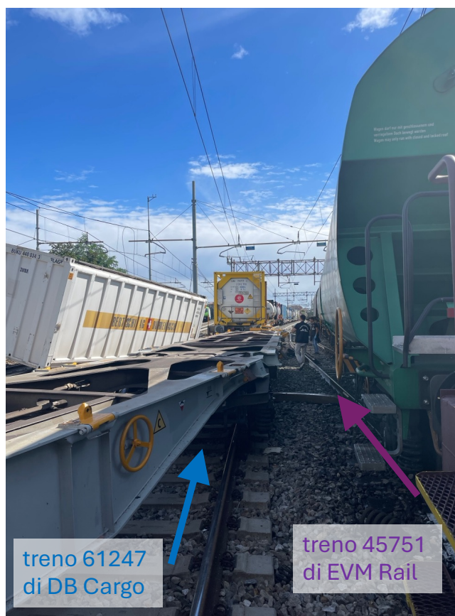
Figura 5 – Dettaglio della zona in cui si è verificato l'evento con particolare riferimento all'ultimo carro del treno 61247 di DB Cargo che trasportava i due container sbalzati in linea a seguito dell'urto (fonte immagine: Commissione di indagine; elaborazione: Commissione di indagine).
