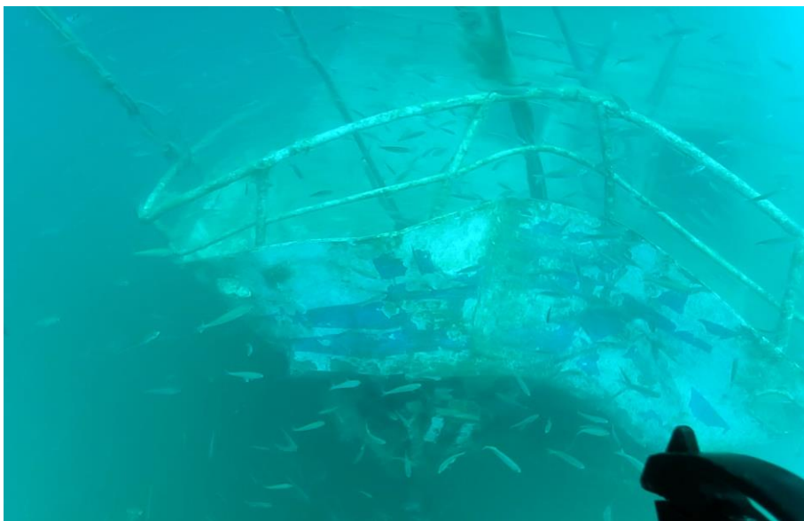
Figura 10 – Area del M/p “ANTONIO PADRE” interessata dalla collisione (lamiera falchetta piegata con corrimano) (fonte: VIDEO EMSA)
