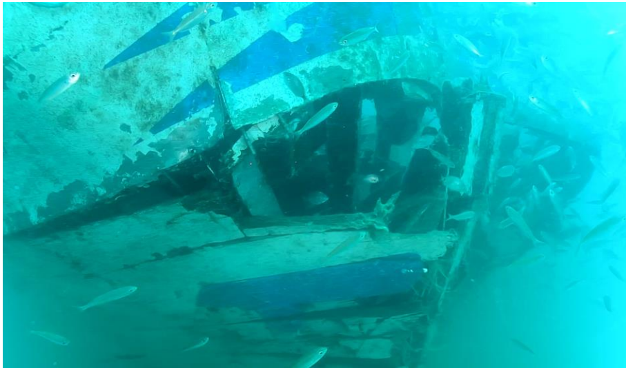
Figura 10 – Area del M/p “ANTONIO PADRE” interessata dalla collisione (lamiera falchetta piegata con corrimano) (fonte: VIDEO EMSA)
