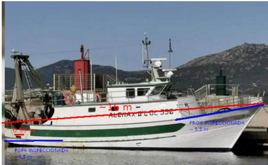
Figura n. 19 – vista longitudinale della M/P “ALEMAX II” con evidenziata la lunghezza dei due tronconi di estremità ispezionati tramite R.O.V. dall’EMSA
