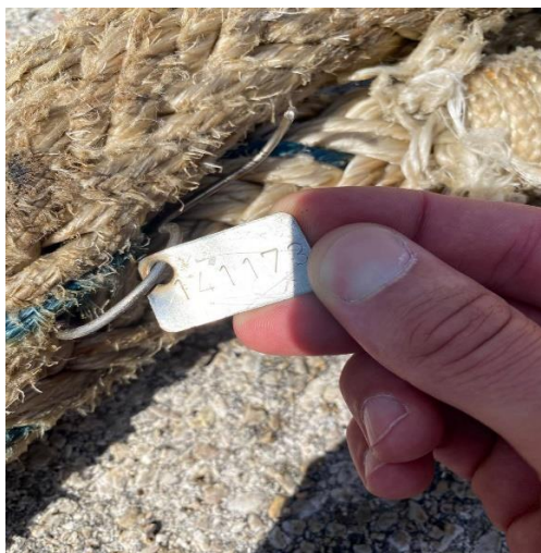
Foto n. 10 - Cavo spring rotto rif. Certificato n. 141173 (fonte Capitaneria di Porto Livorno)
