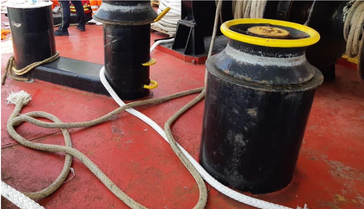
Foto n. 9 - Area di poppa con cavo spring rotto (fonte Capitaneria di Porto Livorno)
