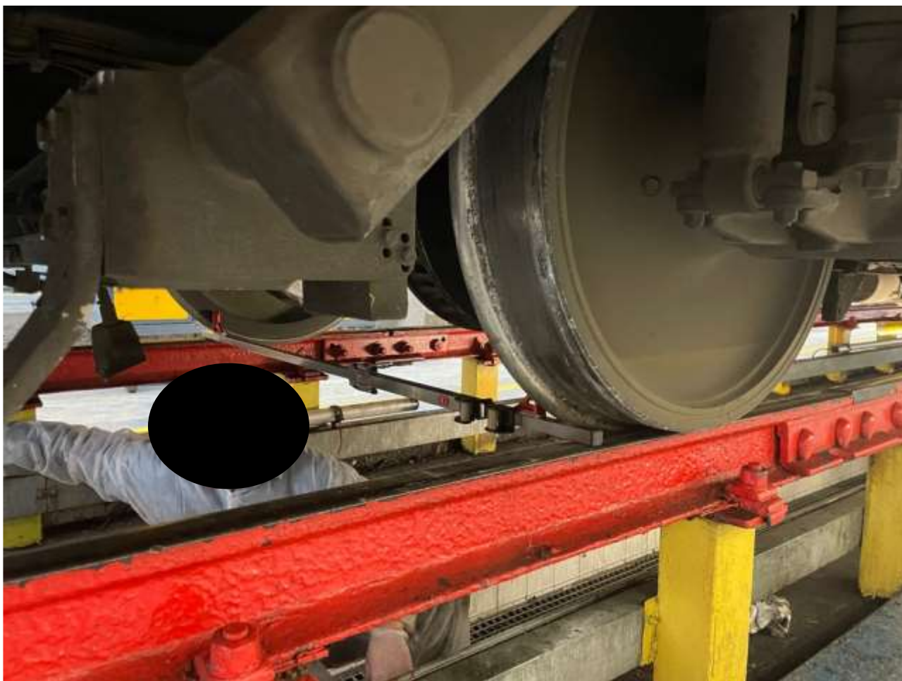
Figura 19 - Attività di misura dello scartamento (fonte immagine: Ufficio; elaborazione: Ufficio).
