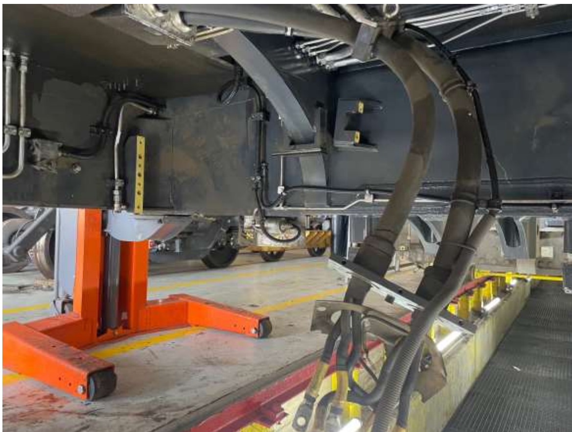
Figura 22 – Attività di ispezione del sottocassa (fonte immagine: Ufficio).
