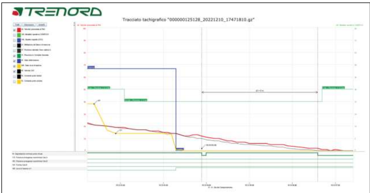
Figura 10 – Dettaglio del tracciato tachigrafico fino al punto di arresto del treno. (fonte immagine: TRENORD).
