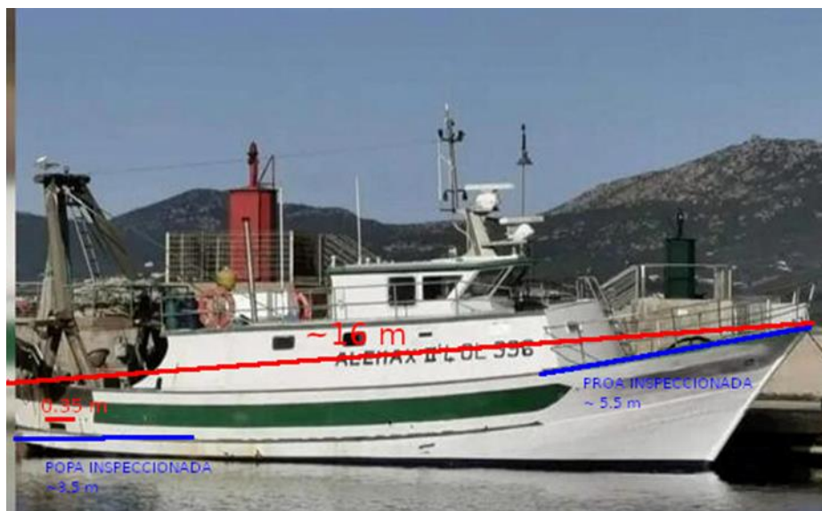
Fig. 6 – Vista longitudinale della M/P “ALEMAX II” con evidenziata la lunghezza dei due tronconi di estremità ispezionati tramite ROV dall’EMSA.
