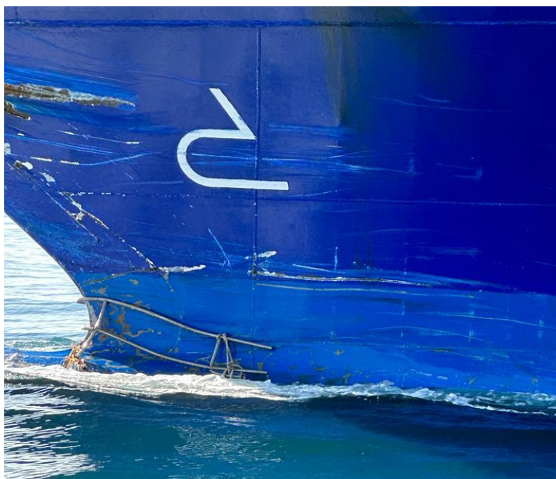
Fig. 9 – Foto scattata dalla Capitaneria di Porto di Livorno alla zona prodiera di sinistra della M/N “SHARDEN” (La zona prodiera di dritta è visibile in Figura 1).
