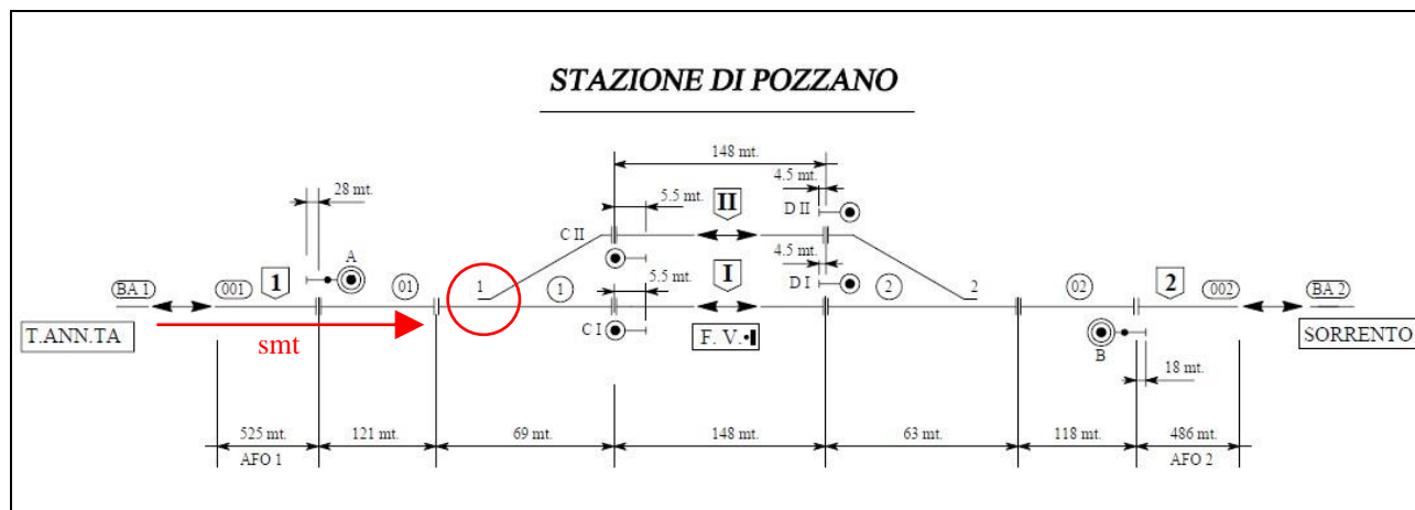
Figura 04: Piano schematico della stazione di Pozzano con indicazione del punto di svio, avvenuto in corrispondenza del deviativo n. 1 (fonte EAV, elaborazione Ufficio).
