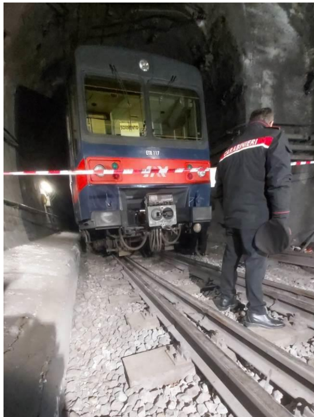
Foto 01: Banchina della stazione di Pozzano (sullo sfondo il convoglio sviato), binario n. 1 (fonte DiGIFeMa) Foto 02: Posizione statica del convoglio dopo lo svio sul deviatoio n. 1 (fonte DiGIFeMa)
