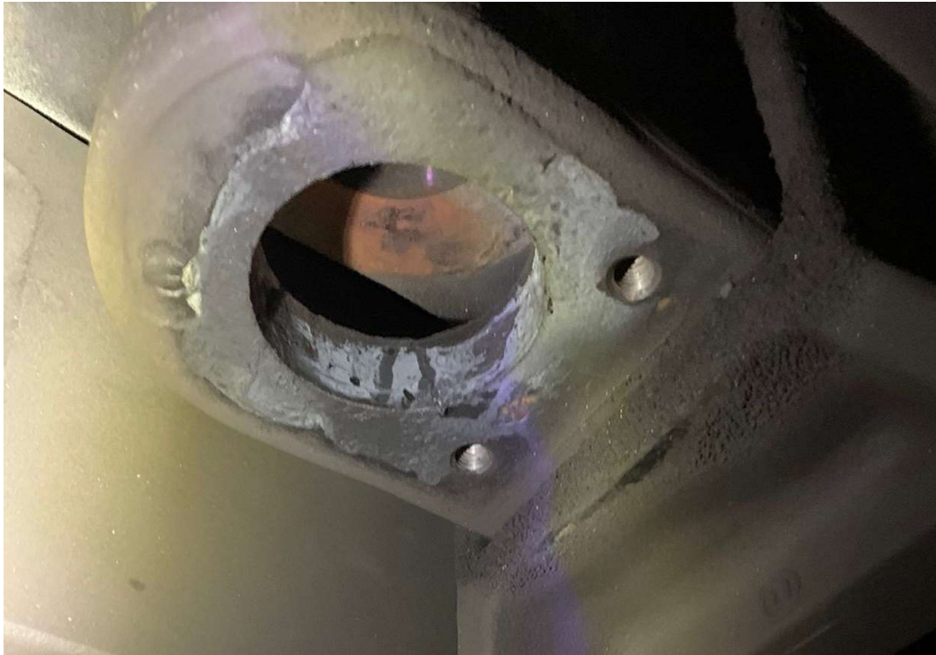
Figura 5 - Castelletto di trazione del carro 33 54 4962 476-6 (fonte GTS)
