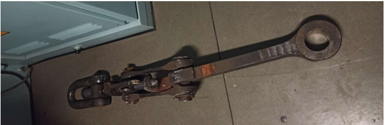
Figura 4 – Gancio di trazione del carro 33 54 4962 476-6 (fonte GTS)
