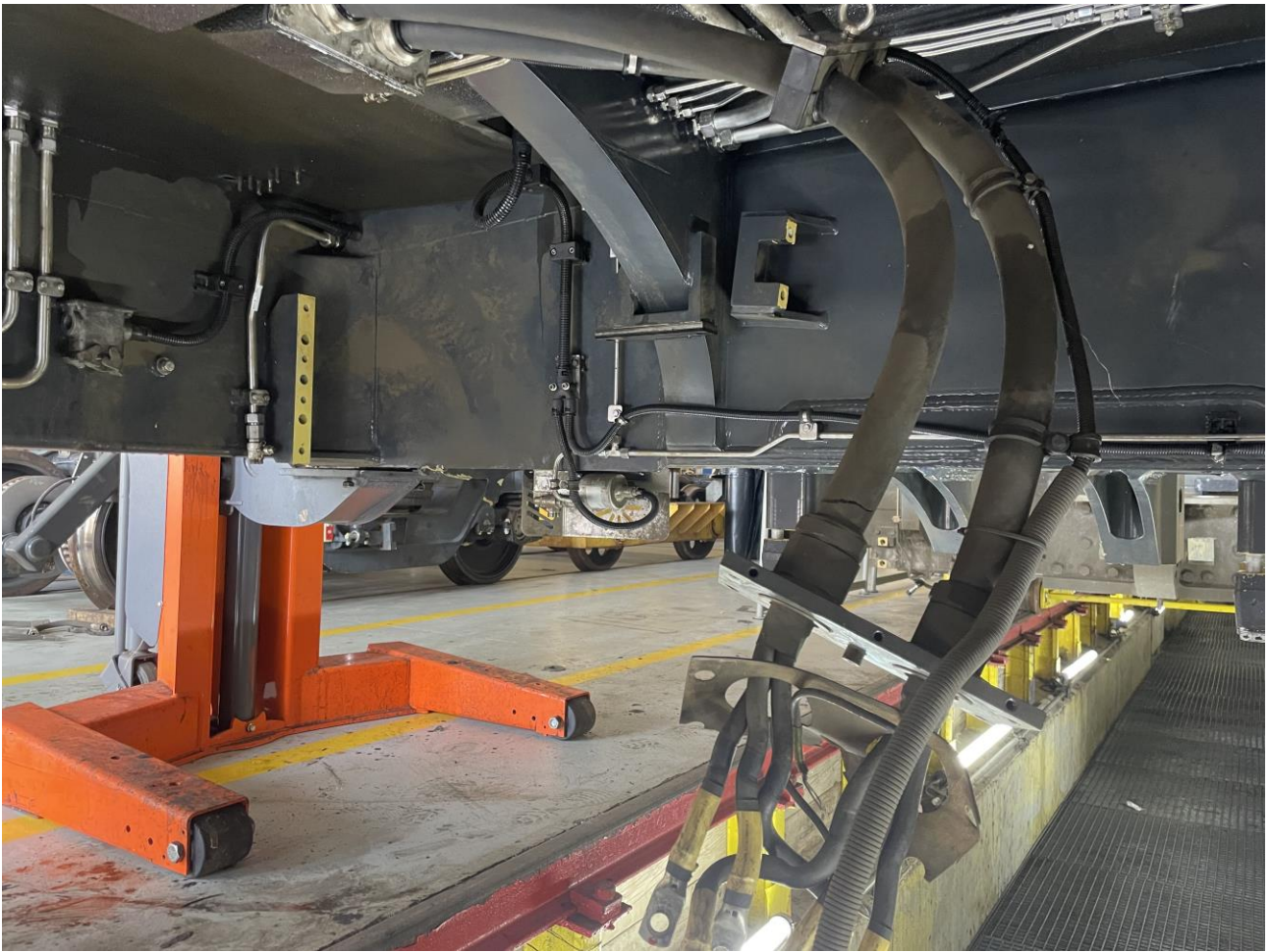
Figura 14 – Attività di ispezione del sottocassa (fonte immagine: DiGIFeMa)
