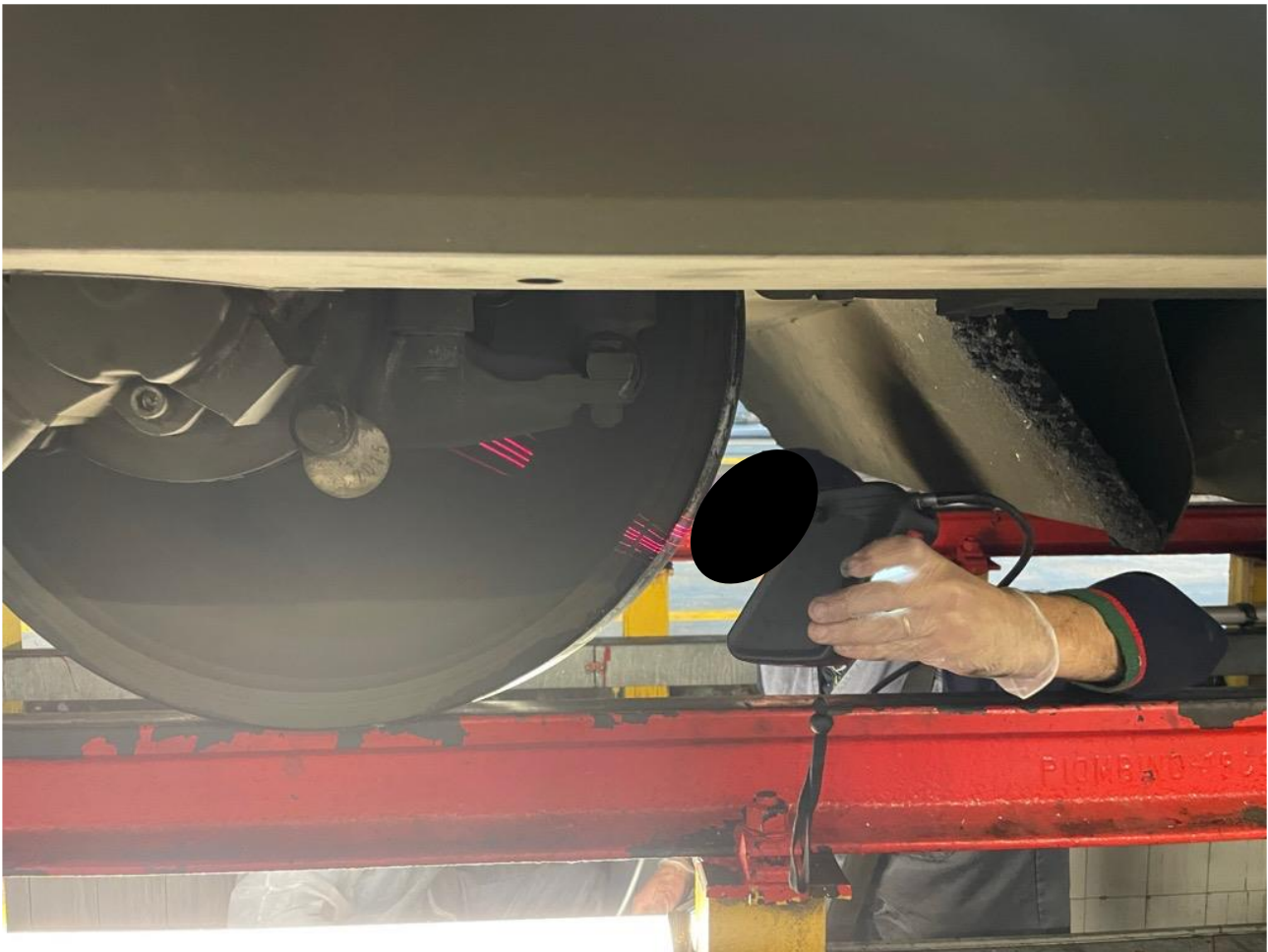
Figura 12 – Attività di misura dei profili delle ruote (fonte immagine: DiGIFeMa; elaborazione: DiGIFeMa)
