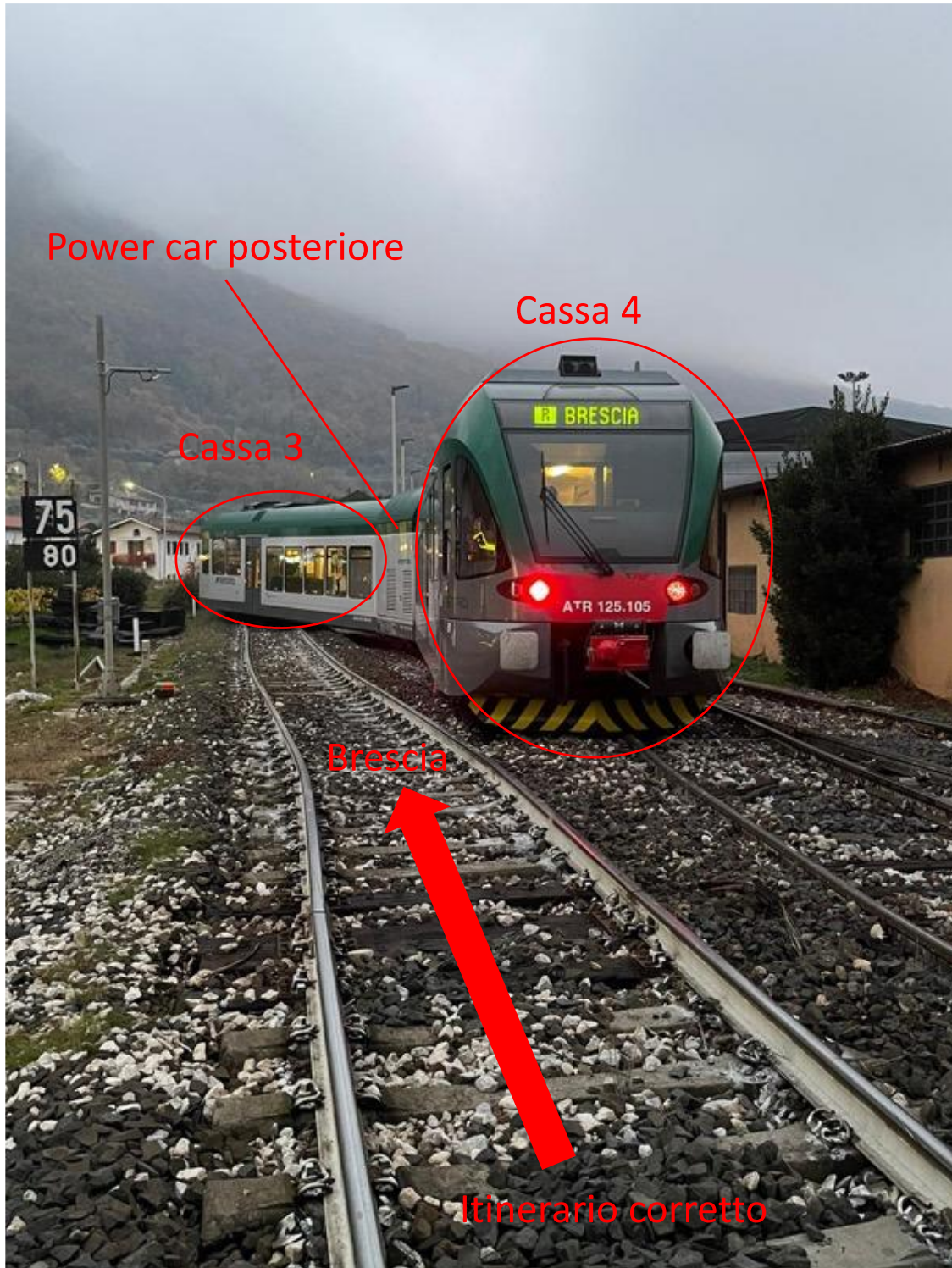
Figura 3 – Localizzazione del treno dopo lo svio, vista lato stazione Iseo (fonte immagine: TRENORD; elaborazione: DiGIFeMa)
