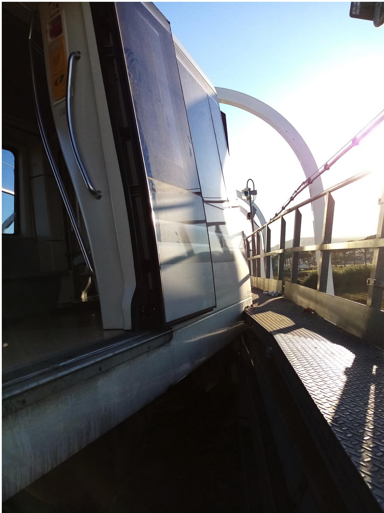
Foto 03: Particolare dell'urto della vettura contro la banchinetta laterale (fonte DiGIFeMa)
