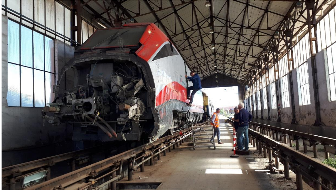
Figura 2: danni riportati dalla cabina della locomotiva E404-656 a seguito dell'urto con le strutture della galleria Serenissima (fonte DiGIFeMa)
