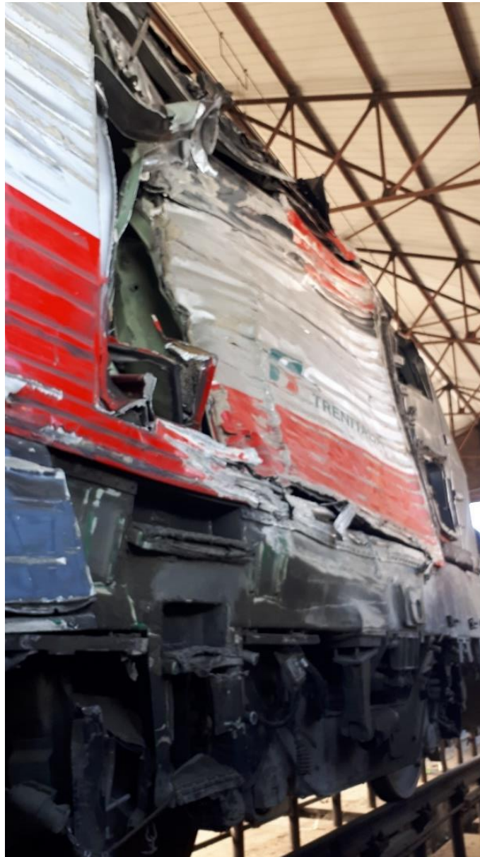
Figura 1: danni riportati dalla fiancata della locomotiva E404-656 a seguito dell'urto con le strutture della galleria Serenissima (fonte DiGIFeMa)
