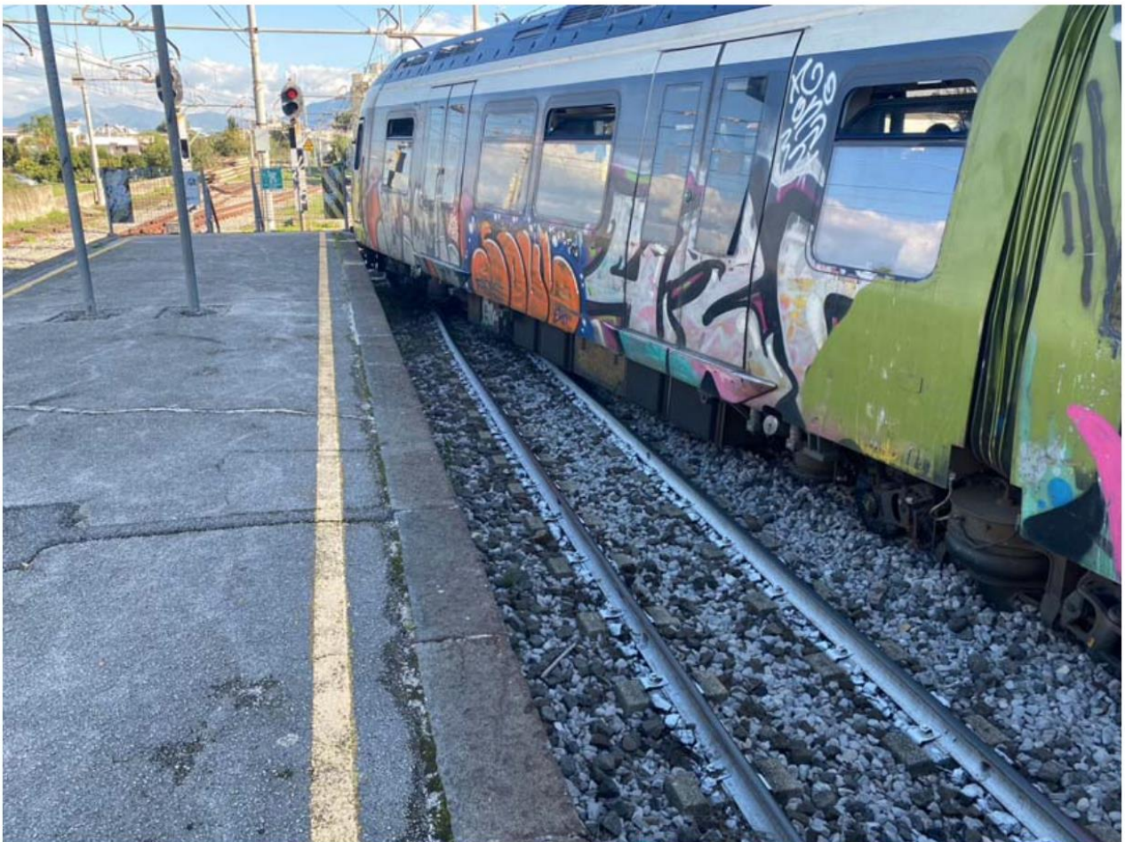
Figura 9 - L'ETR 208 dopo lo svio (fonte: EAV).
