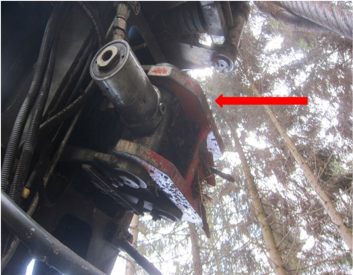
Foto 10 - Forchettone (di colore rosso) installato su una morsa del carrello cabina n.3 del freno sulla portante che ha impedito la chiusura del freno per la rottura della fune traente (fonte DiGIFeMa).
