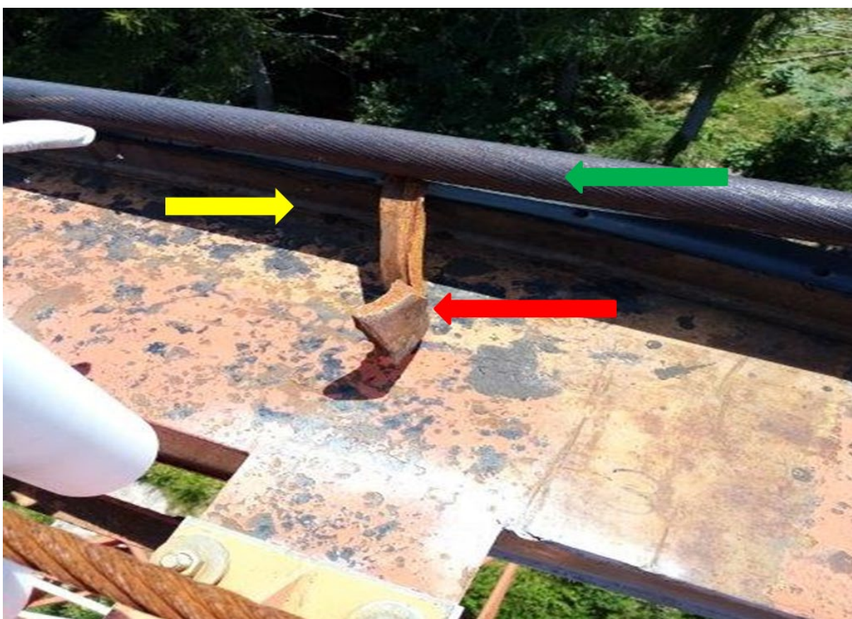
Foto 7 - Parte metallica di lunghezza 25 mm del carrello della cabina 3 (freccia rossa) incastrata tra la scarpa (freccia gialla) e la portante lato veicolo 3 (freccia verde) (Fonte DiGIFeMa).
