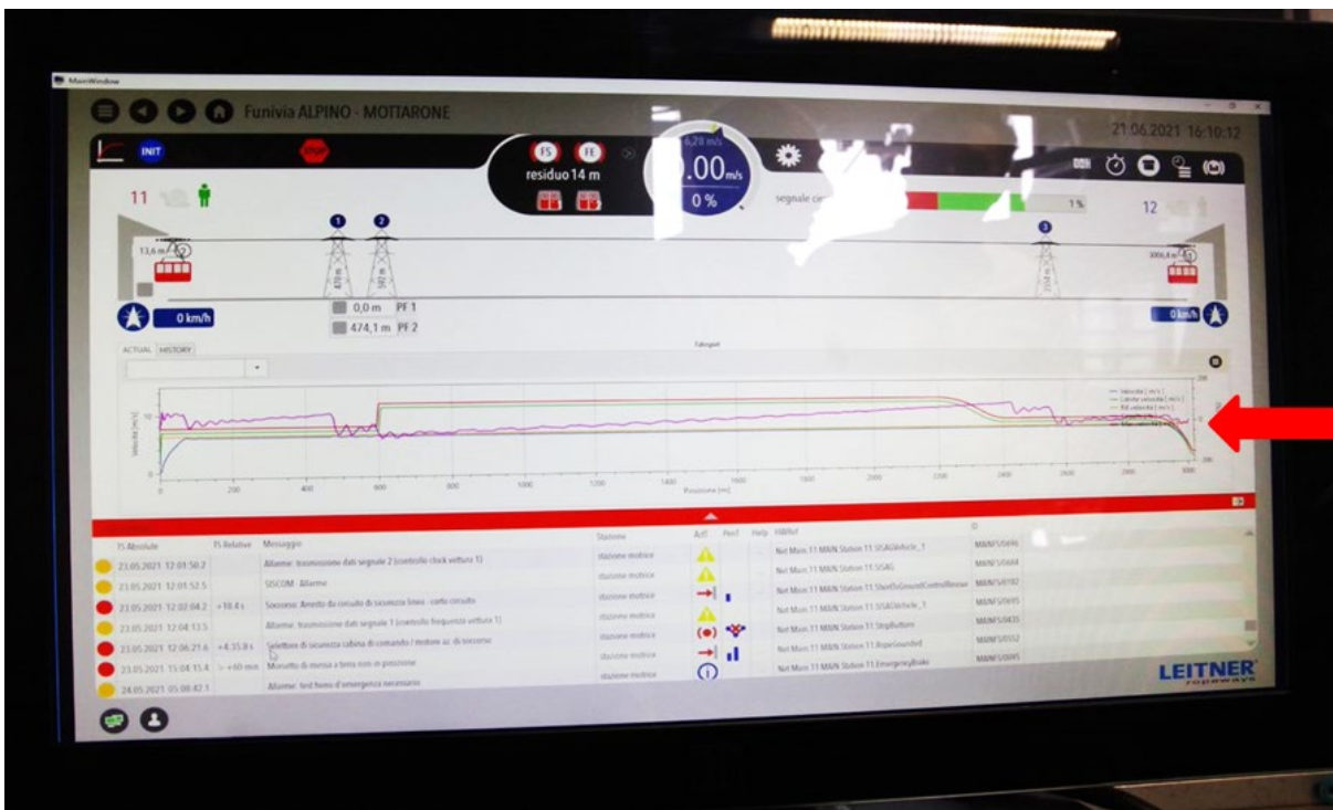
Foto 16 - Diagramma della videata riprodotte la fine della corsa n.13 del 23/05/2021 dalle ore 12:01:45 alle ore 12:02:04 sullo schermo del pulpito di comando e controllo del Circuito di Sicurezza SISAG tipo S-S96P1/P2 SISCOM/FUA; la freccia rossa indica la linea della velocità (fonte DiGiFeMa 21/06/2021).
