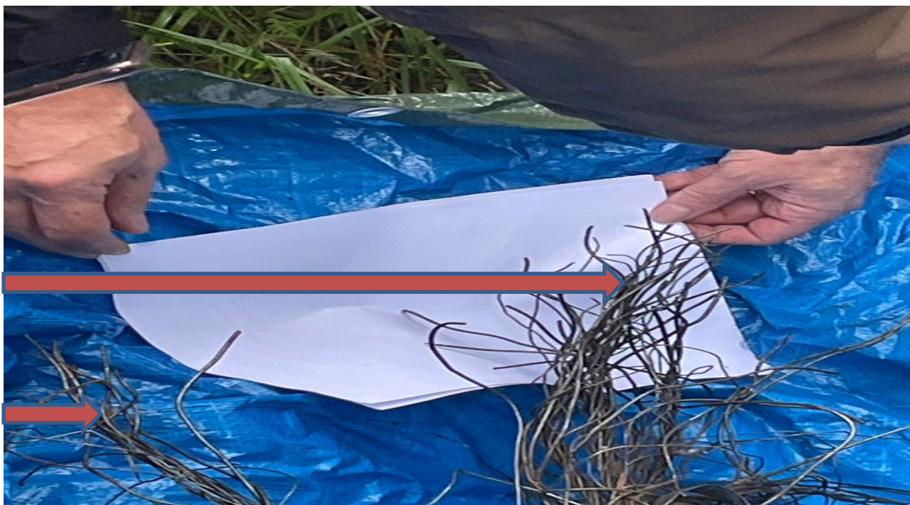
Foto 30 - Fune traente superiore nella zona di rottura dei fili con apertura a pennello dei trefoli e tracce di ossidazione (freccia amaranto) - (Fonte internet).
