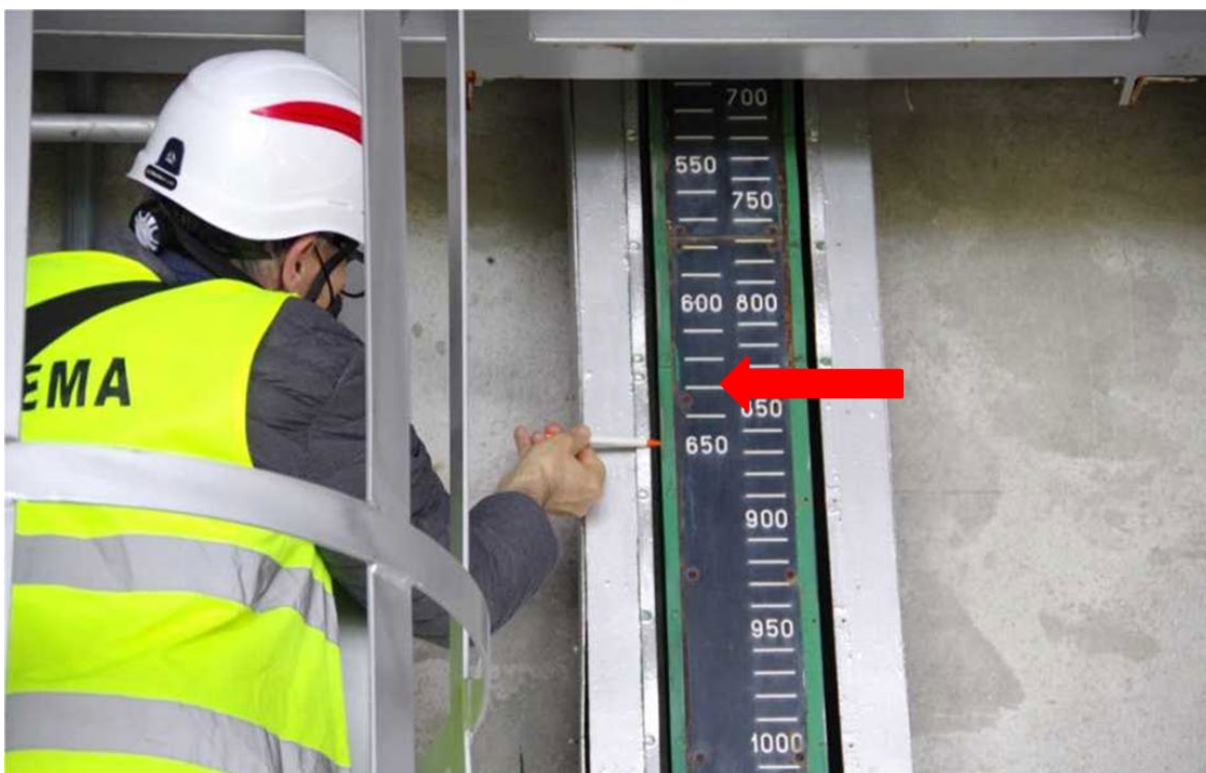
Foto 20 - Particolare delle scale graduate: a sx la scala graduata di escursione del contrappeso della fune traente superiore (freccia rossa), la posizione limite dell'asta pari a 650 cm, segni di sfregamento tra l'indice 600 cm e l'indice 550 cm
