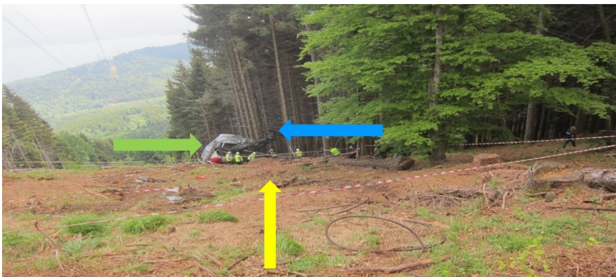
Foto 8 - Zona delimitata di impatto al suolo della cabina 3 (freccia gialla) e albero (freccia azzurra) in cui si è arrestato il rotolamento della cabina (freccia verde) (Fonte DiGIFeMa).
