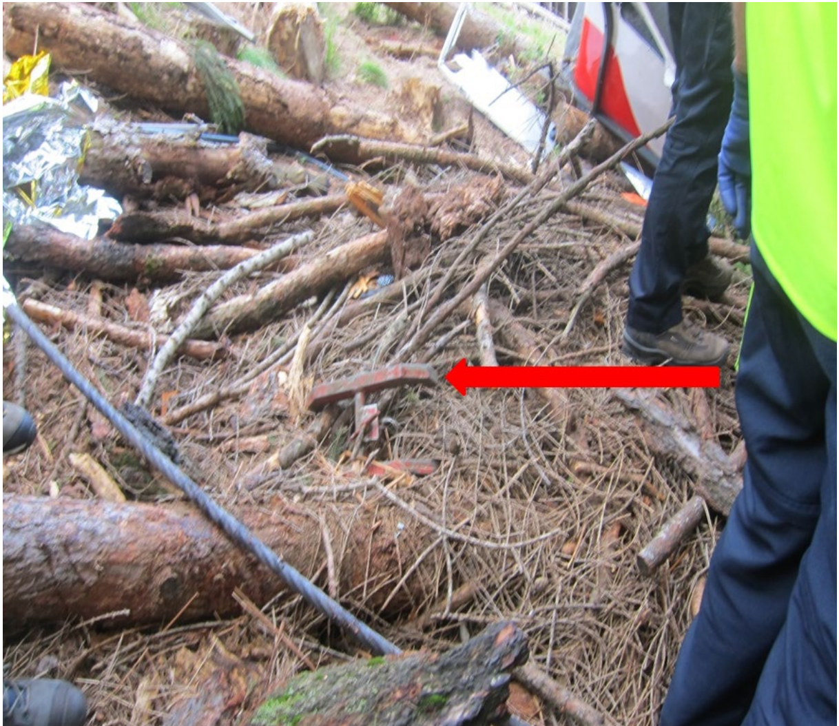
Foto 11 - Forchettone (colore rosso) installato sulla seconda morsa del carrello del freno sulla portante e caduto al suolo dopo l'urto contro l'albero. Anche questo dispositivo ha impedito la chiusura della seconda morsa del freno sulla portante per la rottura della fune traente (Fonte DiGIFeMa).
