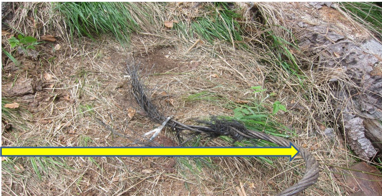
Foto 29 - Fune traente superiore nella zona di rottura, allentamento del passo di cordatura della fune (freccia gialla) - (fonte DiGIFeMa).
