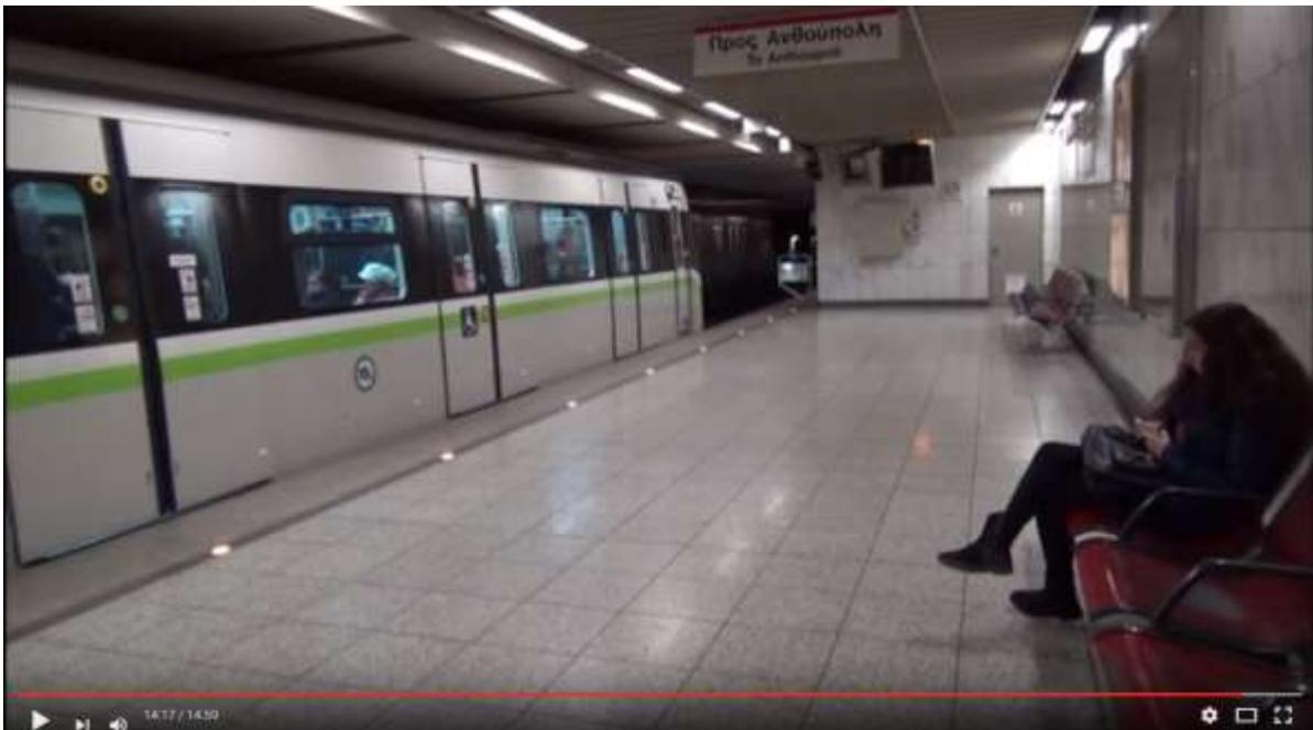
*Foto n. 11c - Esempio di delineatori di margine a LED per banchine. Atene - Metro Linea 2
