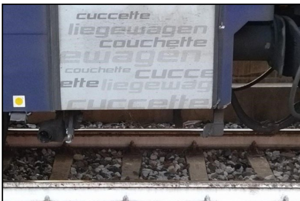
6i. Carrozza danneggiata - predellino mancante (fonte TI)
