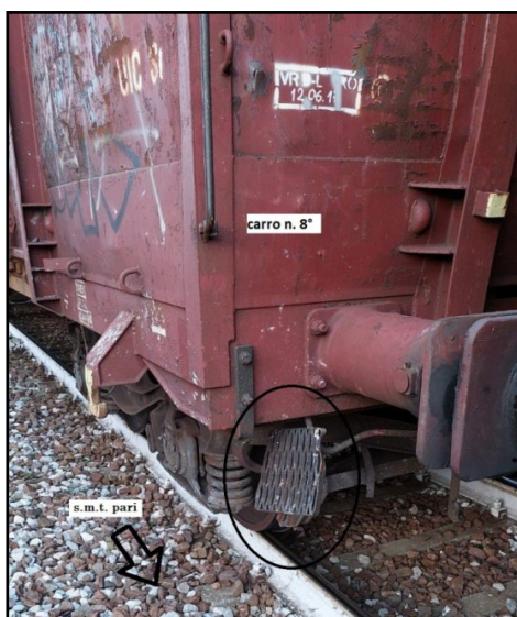
12d. Carro n. 8° - predellino deformato (fonte MIR)
