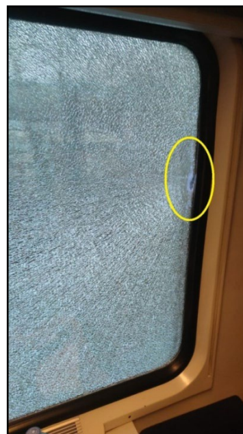
6d. Finestrino crepato (fonte TI)
