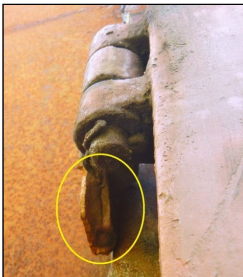
13e. Cerniera inferiore divelta (fonte DiGIFeMa)
