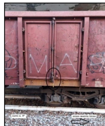
12c. Carro n. 8° - maniglia di chiusura (fonte MIR)
