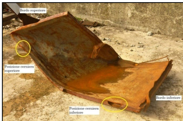
15a. Relitto del portellone faccia interna (fonte DiGIFeMa)
