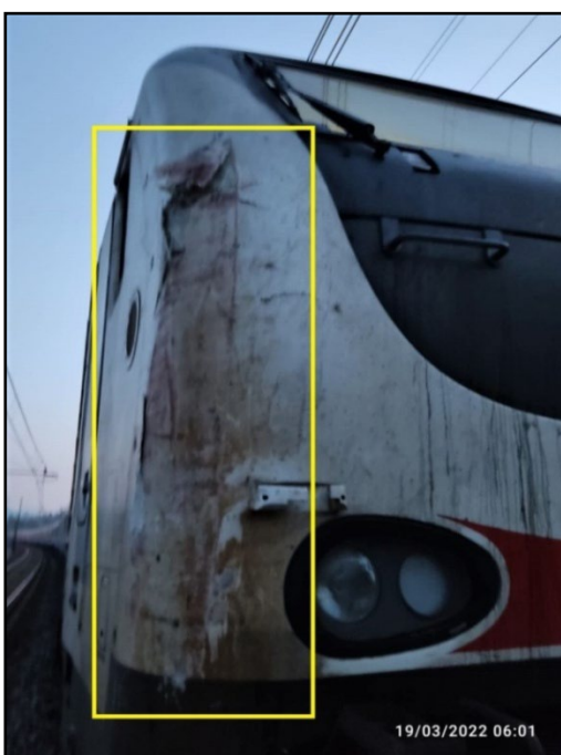
6a. Tratto in linea – Loc. E402-171 – Zona urto (fonte TI)
