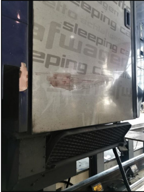
6e. Carrozza danneggiata (fonte TI)
