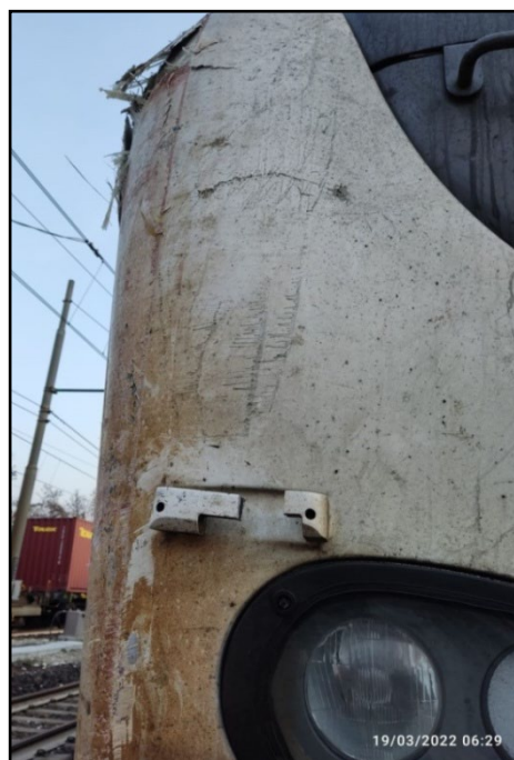
6b. Località Pianoro – Loc. E402-171 – Particolare danni (fonte MIR)
