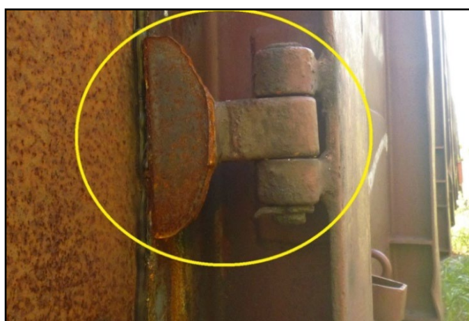
13d. Cerniera inferiore divelta (fonte DiGIFeMa)
