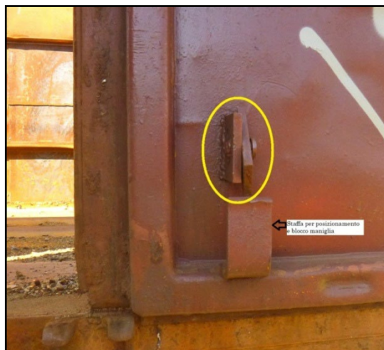
8e. Dispositivo di sicurezza (fonte DiGIFeMa)
