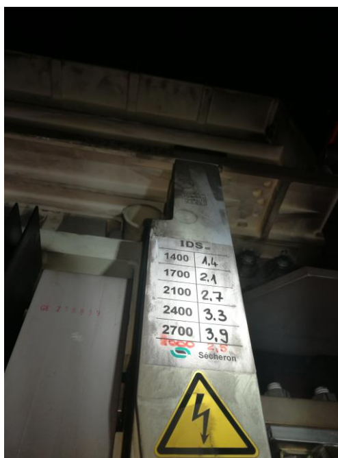
15. Scala graduata di taratura del JR e scala di conversione (Fonte DiGIFeMa)
