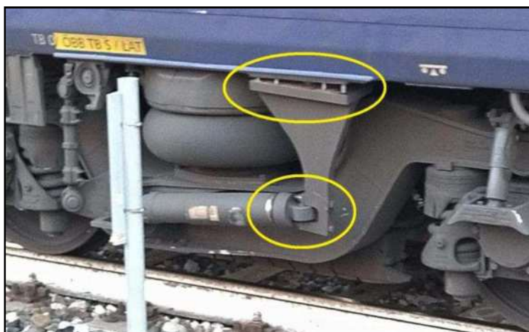
9/h. Ammortizzatore e staffa danneggiati (fonte MIR)
