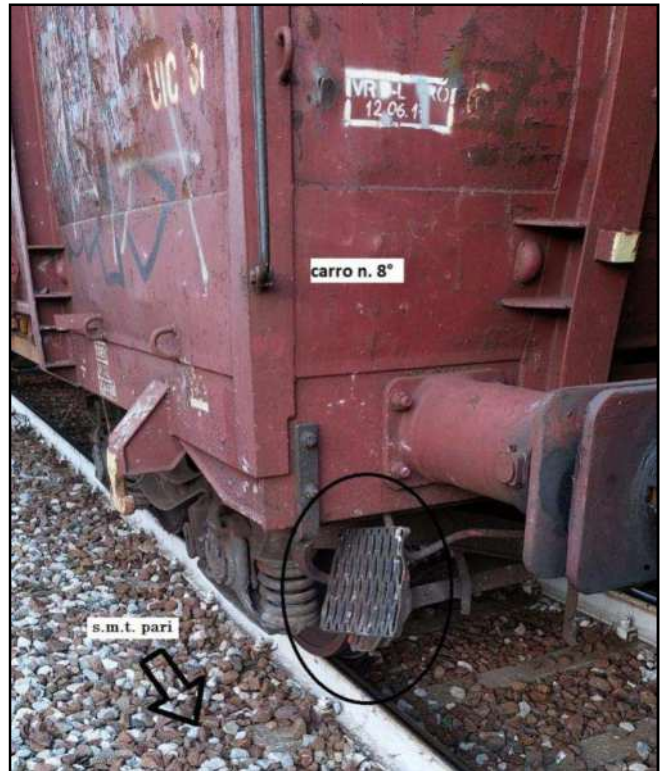
16/d. Carro n. 8 - predellino deformato (fonte MIR)
