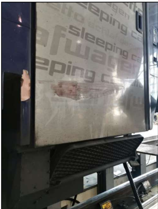
9/e. Carrozza danneggiata (fonte TI)
