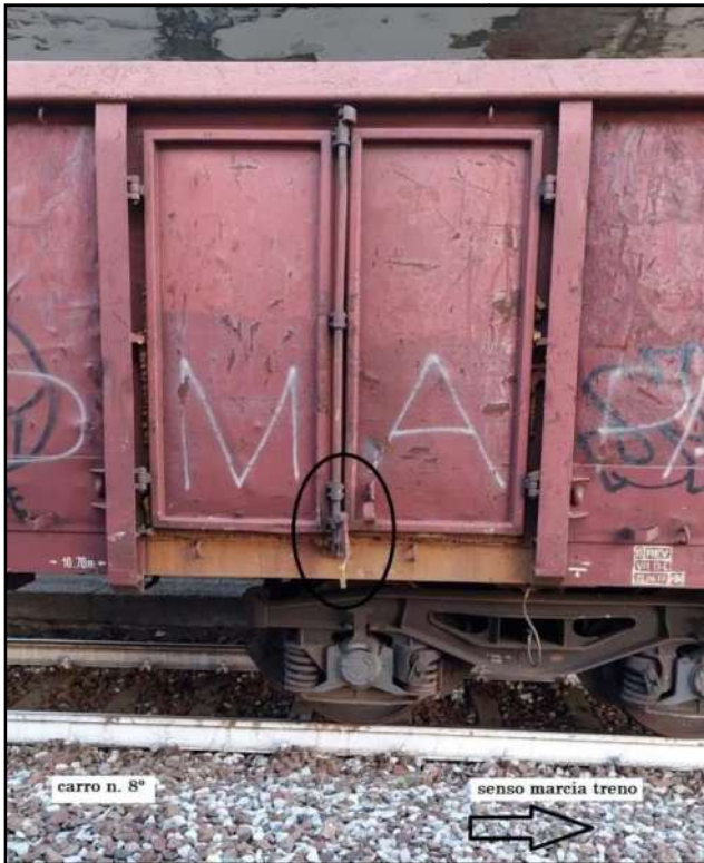
16/c. Carro n. 8 - maniglia di chiusura (fonte MIR)
