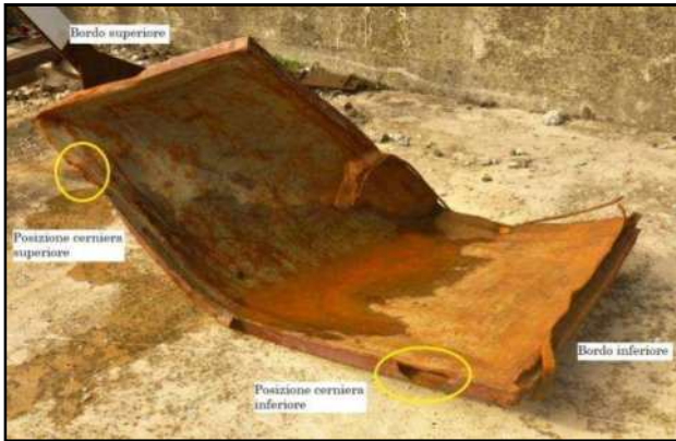
20/a. Relitto del portellone faccia interna (fonte DiGIFeMa)
