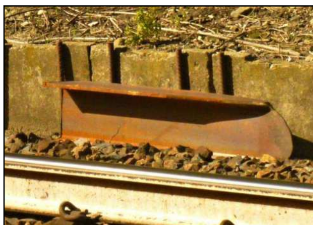
19/f. Rottame ferroso perso in linea (fonte DiGIFeMa)
