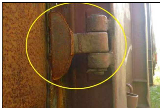
18/d. Cerniera inferiore divelta (fonte DiGIFeMa)
