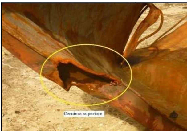
20/e. Particolare posizione cerniera superiore (fonte DiGIFeMa)
