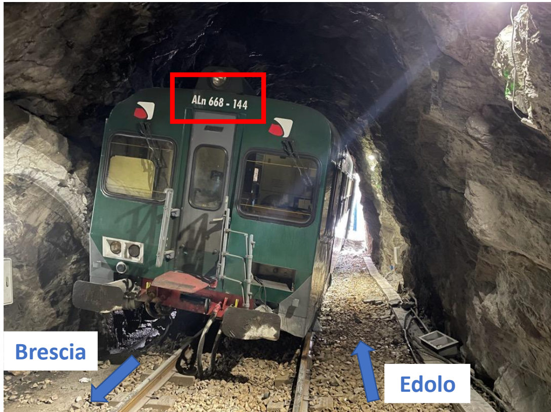
Figura 2 – Prima vettura del treno in direzione Brescia; fronte dell'Automotrice ALn 668 -144 dopo lo scavalco del masso e lo svio. (fonte: Commissione d'indagine - sopralluogo del 10/12/2021).
