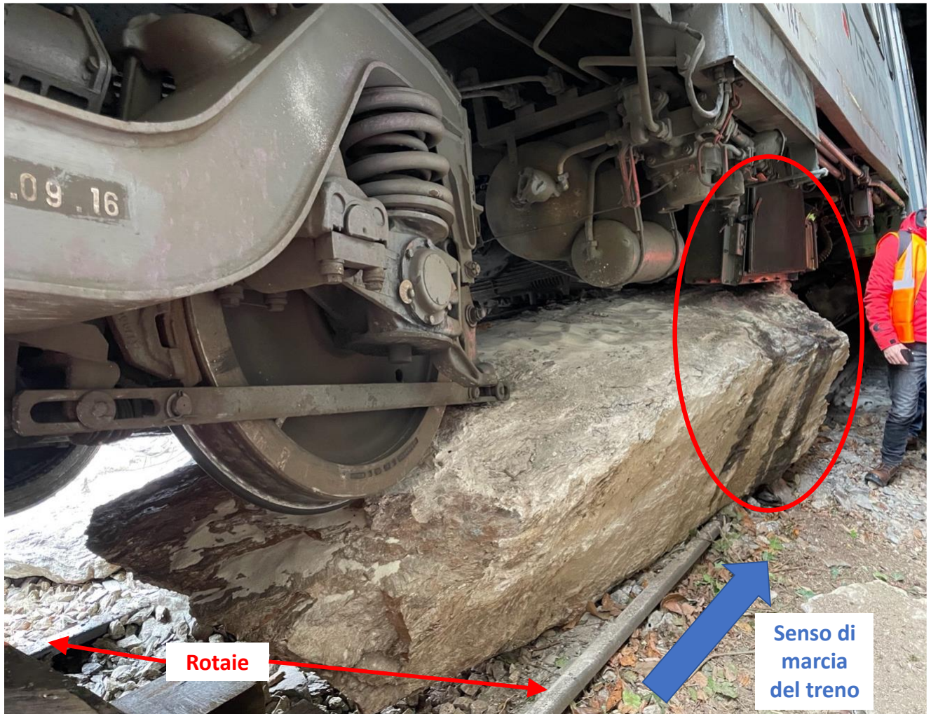
Figura 4 – Carrello posteriore dell'Automotrice ALn 668 -144 e rilascio di liquidi dal motore (fonte: Commissione d'indagine - sopralluogo del 10/12/2021).
