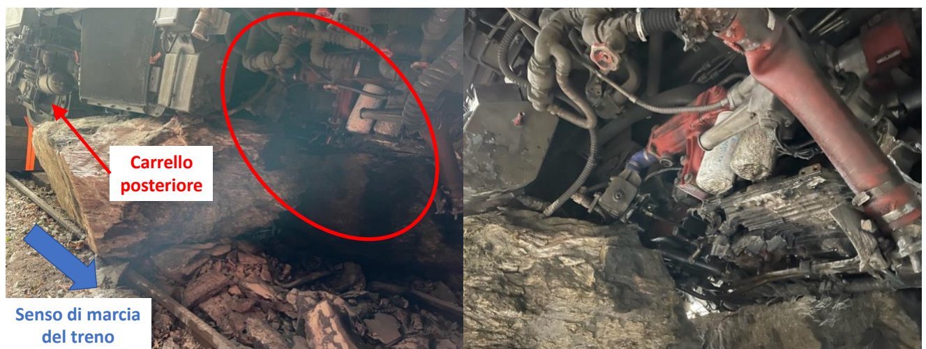
Figura 6 – Impatto del motore e delle componenti meccaniche dell’Automotrice ALn 668 -144 contro il masso. A destra un ingrandimento della zona cerchiata in rosso (fonte: Commissione d’indagine - sopralluogo del 10/12/2021).
