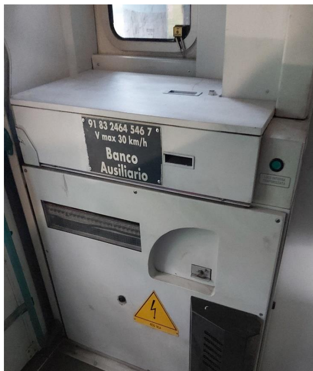
Figure 22 e 23 – Banco di manovra ausiliario della locomotiva E464.546 (fonte: DiGIFeMa – 23/02/2021)
