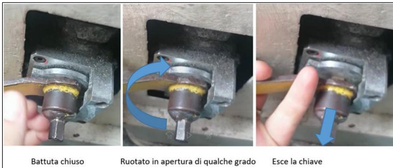
Figura 13 – Rubinetto di intercettazione MIF su vettura pilota (fonte: Trenord)
