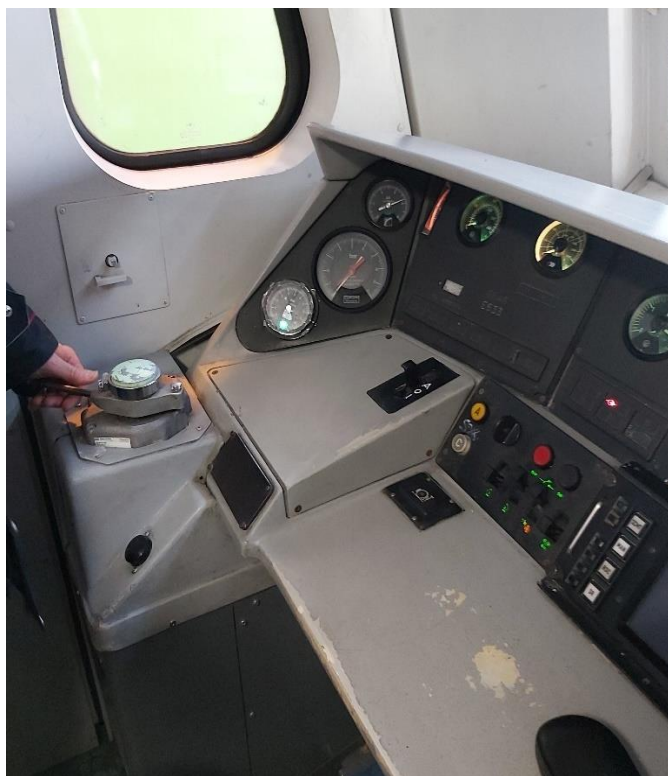
Figure 24 e 25 – Banco di manovra della vettura pilota. Sulla sinistra l'operatore agisce sul manipolatore Oerlikon del freno, a sinistra dettaglio della maniglia di intercettazione dell'impianto frenante (fonte: DiGIFeMa – 23/02/2021)
