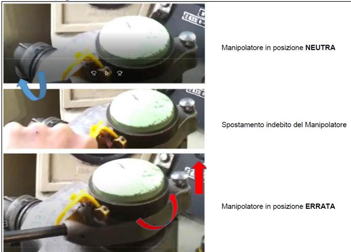
Figura 12 – Manipolatore Oerlikon su vettura pilota (fonte: Trenord)
