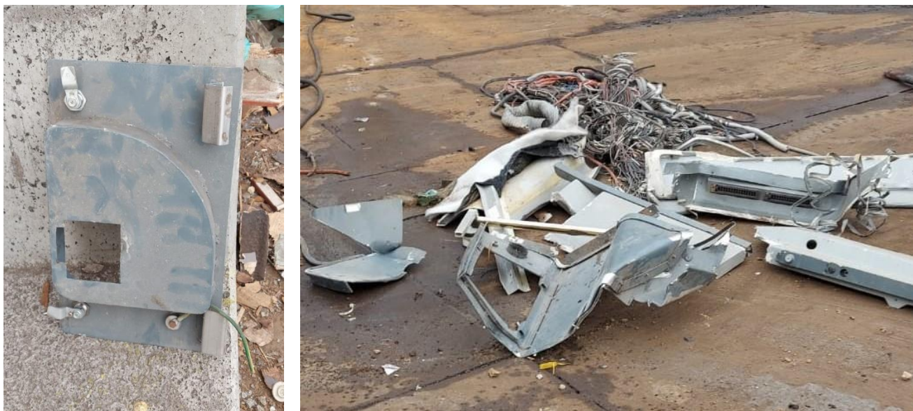
Figure 34 e 35 – Accertamenti tecnici effettuati a Cairo Montenotte (SV) il 15/09/2021 sulla vettura pilota incidentata; dettaglio del carter metallico di alloggiamento della maniglia “gialla” per l’azionamento del rubinetto di intercettazione del freno MIF e resti del banco di manovra (fonte: DiGIFeMa)
