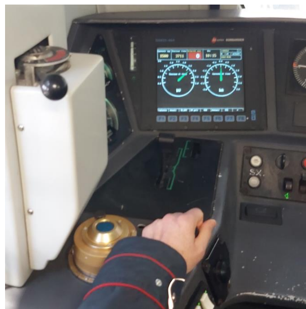
Figure 20 e 21 – Banco di manovra principale della locomotiva E464.546 (fonte: DiGIFeMa – 23/02/2021)
