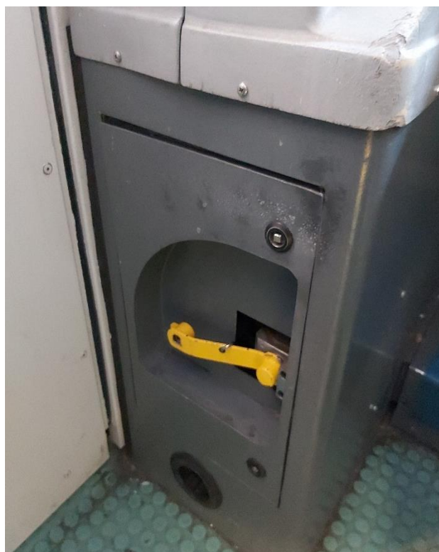
Figure 24 e 25 – Banco di manovra della vettura pilota. Sulla sinistra l'operatore agisce sul manipolatore Oerlikon del freno, a sinistra dettaglio della maniglia di intercettazione dell'impianto frenante (fonte: DiGIFeMa – 23/02/2021)
