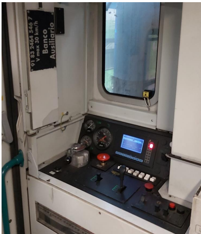
Figure 22 e 23 – Banco di manovra ausiliario della locomotiva E464.546 (fonte: DiGIFeMa – 23/02/2021)
