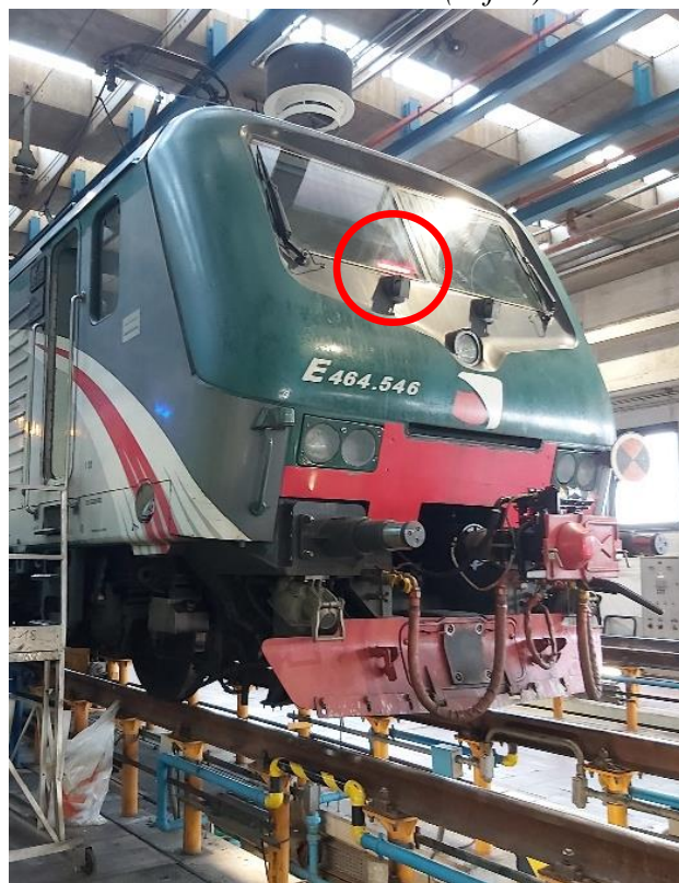
Rif. 3: segnalatore luminoso a led rossi sul vetro frontale (fonte: DiGIFeMa)
