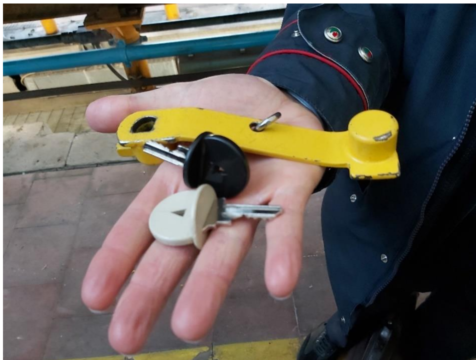
Rif. 1 – Chiave NERA di sblocco della pulsantiera, chiave BEIGE di inserzione REC e maniglia GIALLA di intercettazione del freno (fonte: DiGIFeMa)
