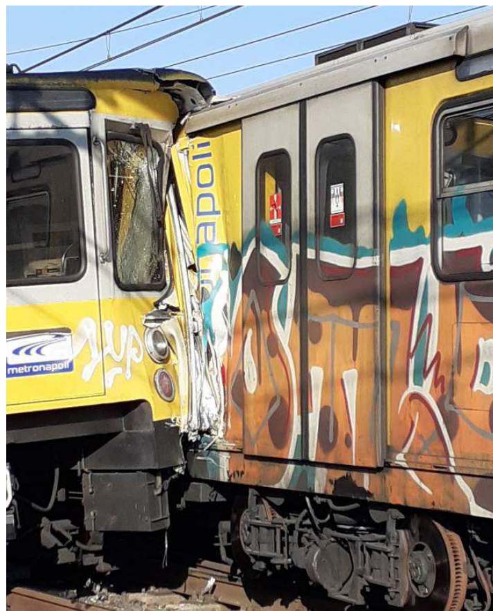
Figura 11 - Dettaglio delle zone di impatto delle UdT 13 del treno n. 1, a sinistra, e dell'UdT 9 del treno n. 8, a destra (fonte: ANM SpA)
