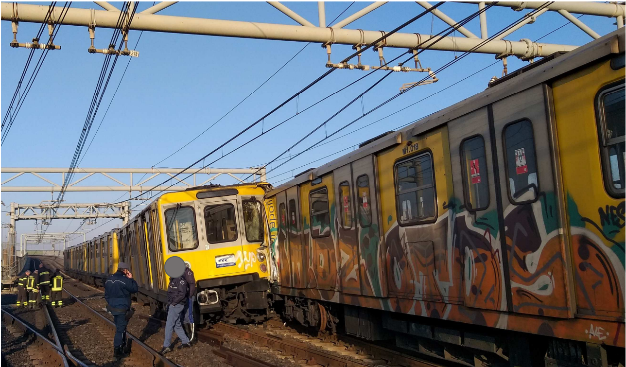
Figura 10 - Posizione dell'UdT 13 del treno n. 1 (a sinistra) e dell'UdT 9 del treno n. 8 (a destra) dopo l'impatto avvenuto in prossimità del cuore del deviativo 2a (fonte: ANM SpA)
