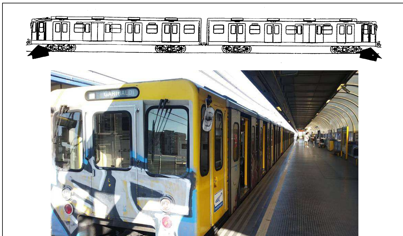
Figura 15 - Figurino (in alto) e foto (in basso) delle elettromotrici della serie M1, in composizione UdT+UdT, in esercizio sulla Linea 1 della Metropolitana di Napoli (Fonte: ANM SpA)
