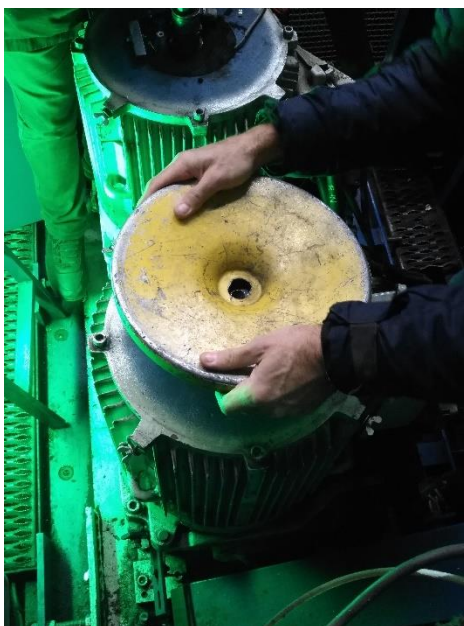
Figura 56 – Azionamento manuale della scala 54NF6338 tramite volantino (fonte Digifema)
