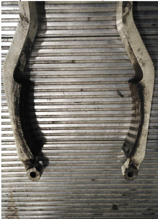
Figure 59 e 60 – Leve dei freni d'esercizio del motore 2 della scala mobile matr. 54NF6339 e schema grafico con evidenza del senso di rotazione (fonte Digifema)
