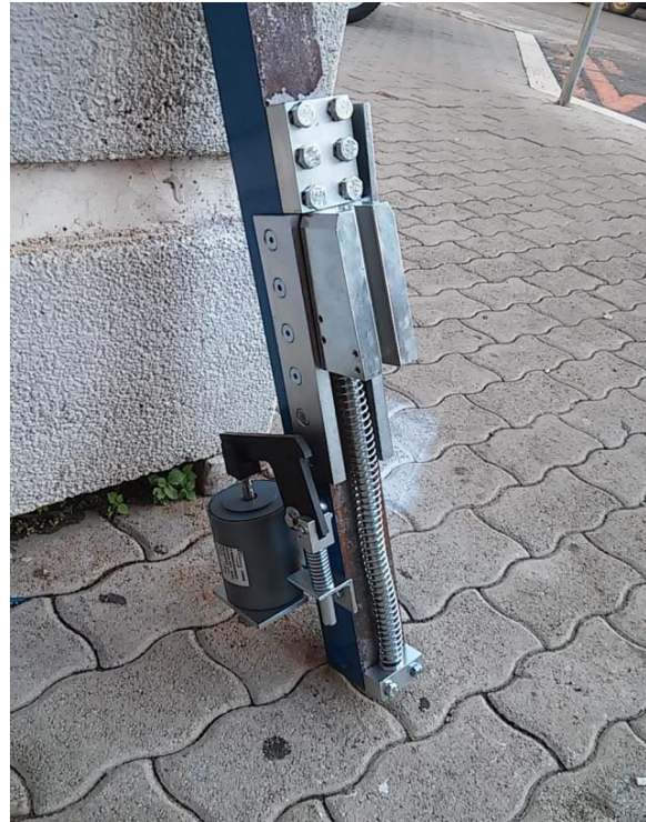
Figure 48 e 49 – Freno d'emergenza (fonte Digifema)
