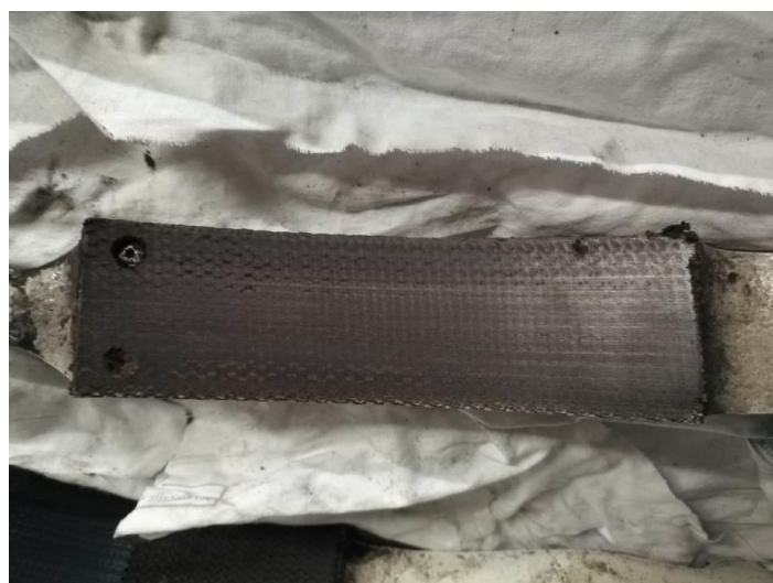
Figura 61 – Ferodo, con superficie consumata in modo uniforme, del freno d'esercizio della scala mobile matr. 54NF6338, non incidentata (fonte Digifema)
