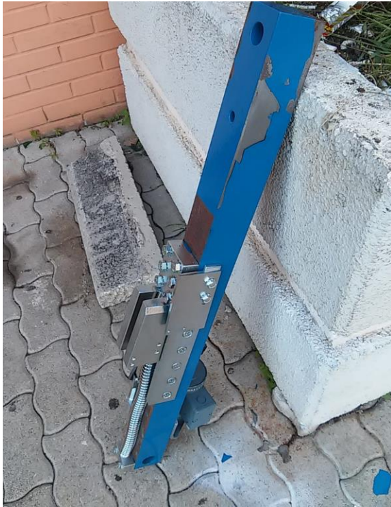
Figure 48 e 49 – Freno d'emergenza (fonte Digifema)
