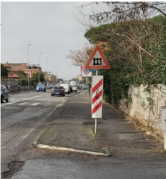
Figure 20 - Pannelli distanziometrici 11/a e 11/b sulla SP127 in direzione Ciampino (fonte Digifema)
