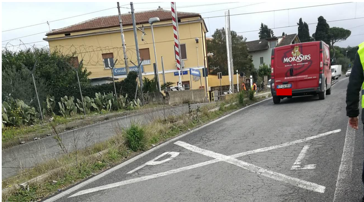
Figura 25 - Segnaletica orizzontale di avviso di presenza di PL ferroviario sulla SP127 in direzione Velletri (fonte Digifema)
