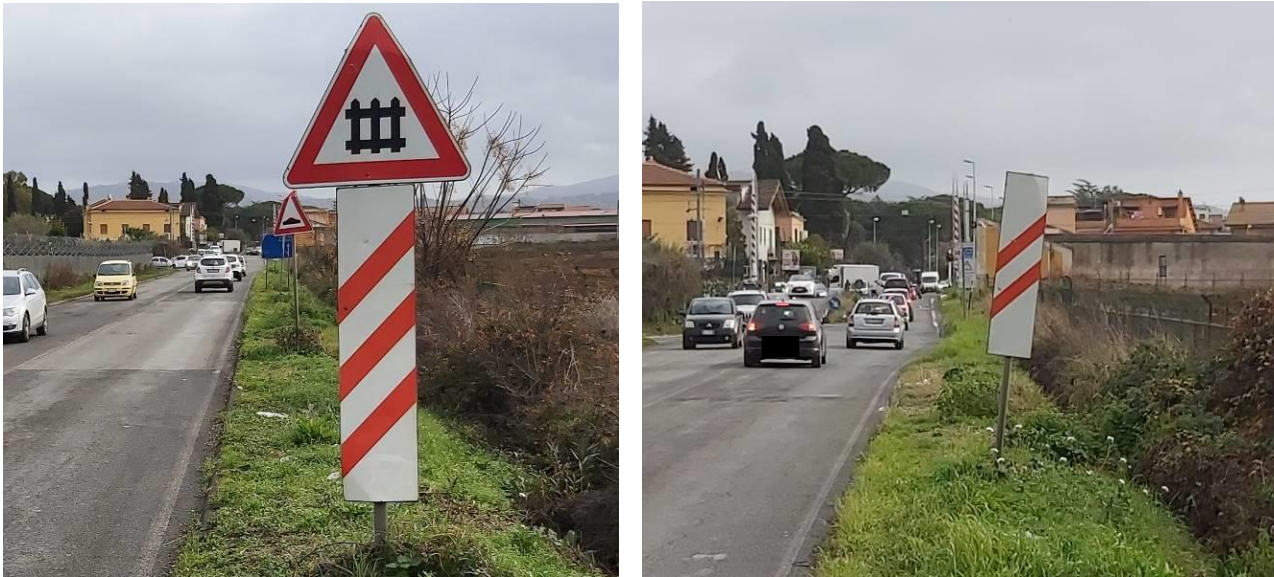
Figure 21 - Pannelli distanziometrici 11/a e 11/b sulla SP127 in direzione Velletri (fonte Digifema)
