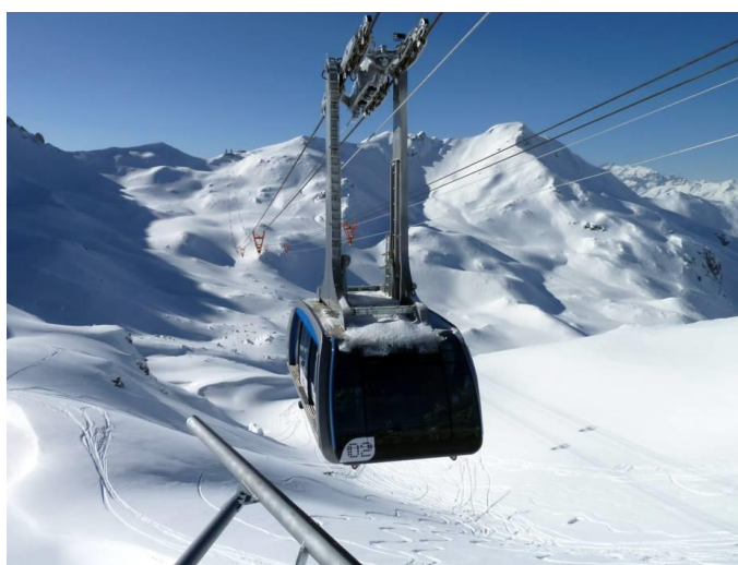
Foto n. 24 - Funivia Hörnli - Urderfurggli (CH), costruttore Steurer 2016, 150 posti, doppia via di corsa ( fonte internet )
