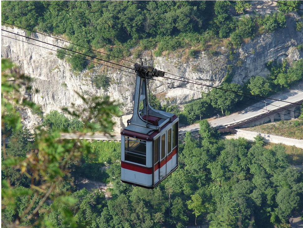
Foto n. 18 - Funivia Trento - Sardinia (Trento), Lenzi 1964, Hölzl 1989, (13 posti), 1 via di corsa, 1 cabina, campata unica ( fonte internet )
