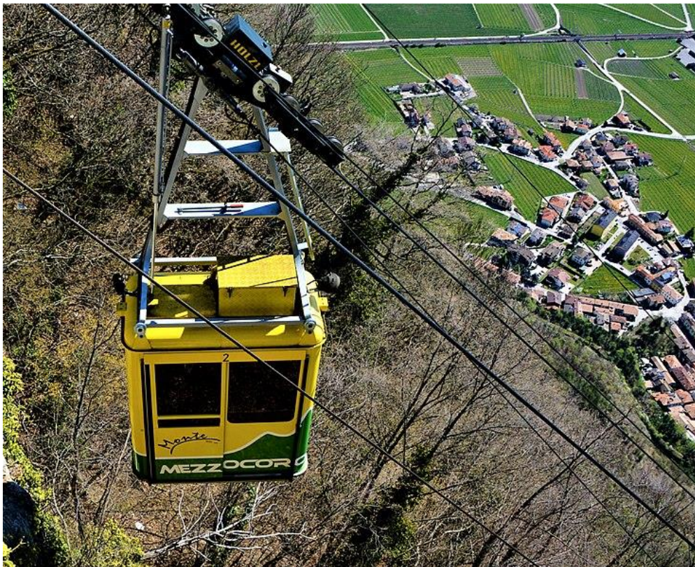
Foto n. 17 - Funivia Mezzocorona – Monte (Trento), Lenzi 1965 (a. costruzione), Hölzl - Doppelmayr 2005 (7 posti), 2 cabine, campata unica ( fonte internet )
