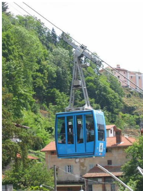
Foto n. 22b - Funivia Varallo - Sacro Monte (Piemonte) 2002, 15 posti, 2 cabine, campata unica ( fonte internet )
