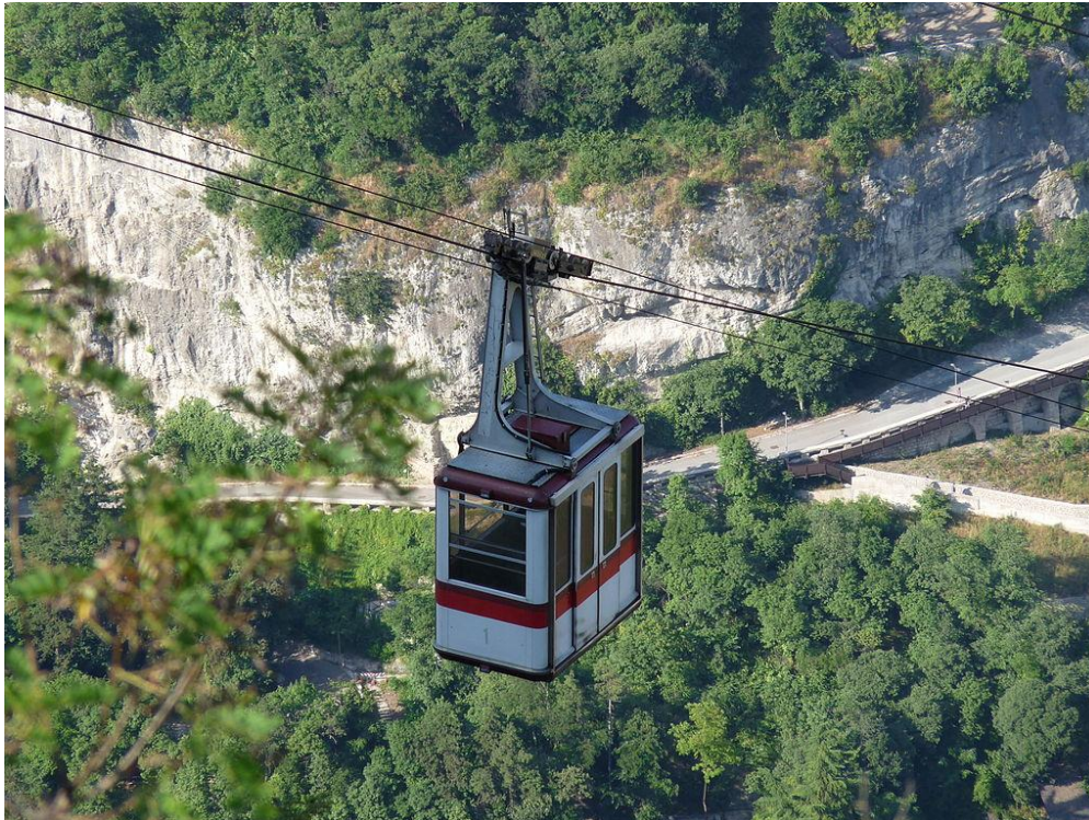
Foto n. 16 - Funivia Verdines – Talles (Bolzano), Schwiennbacher 1971, (15 posti), cabine rifatte nel 2011, 2 sostegni ( fonte internet )
