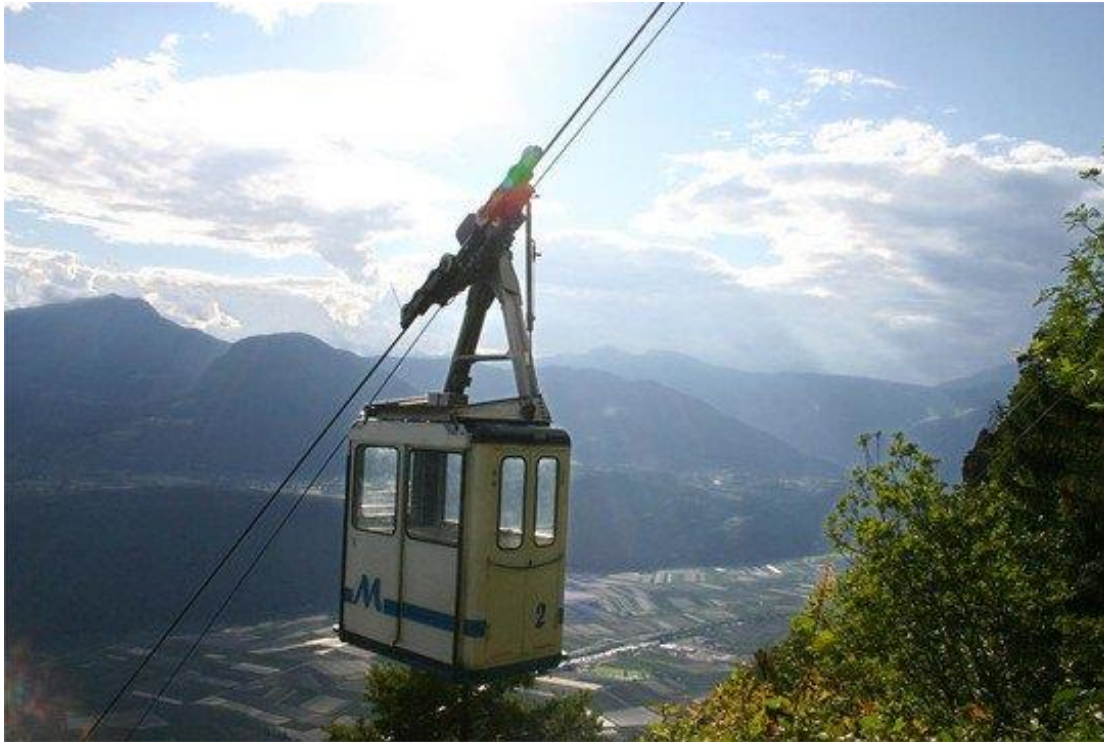
Foto n. 14 – Vilpiano - Meltina (Bolzano), Hölzl (12 posti), 1 via di corsa, 1 cabina, campata unica ( fonte internet )
