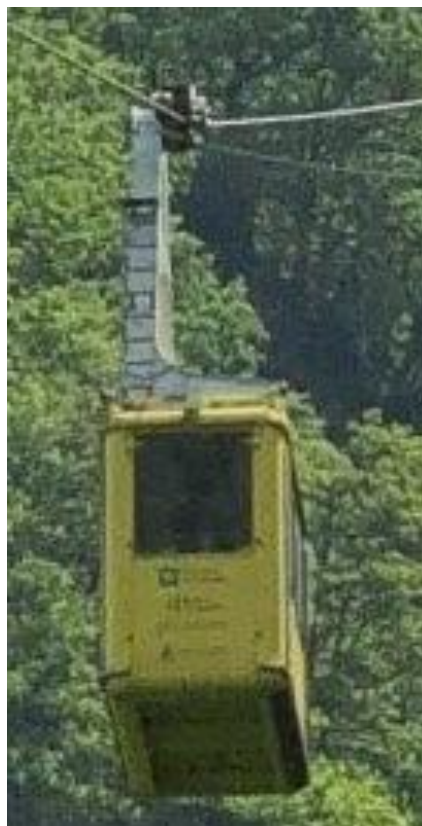
Foto n. 19 - Funivia Ponte di Piero - Monteviasco (Varese, Lombardia), Holzl 1989, (15 posti), 1 via di corsa, 1 cabina, 1 sostegno ( fonte archivio antecedente revisione generale 2011 )
