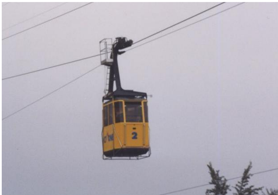
Foto n. 23 - Funivia Passo del Lupo - Pian Cavallaro (Monte Cimone, Regione Emilia Romagna), Hölzl 1965, (21 posti), cabine rifatte nel 2015, 1 sostegno ( fonte internet )
