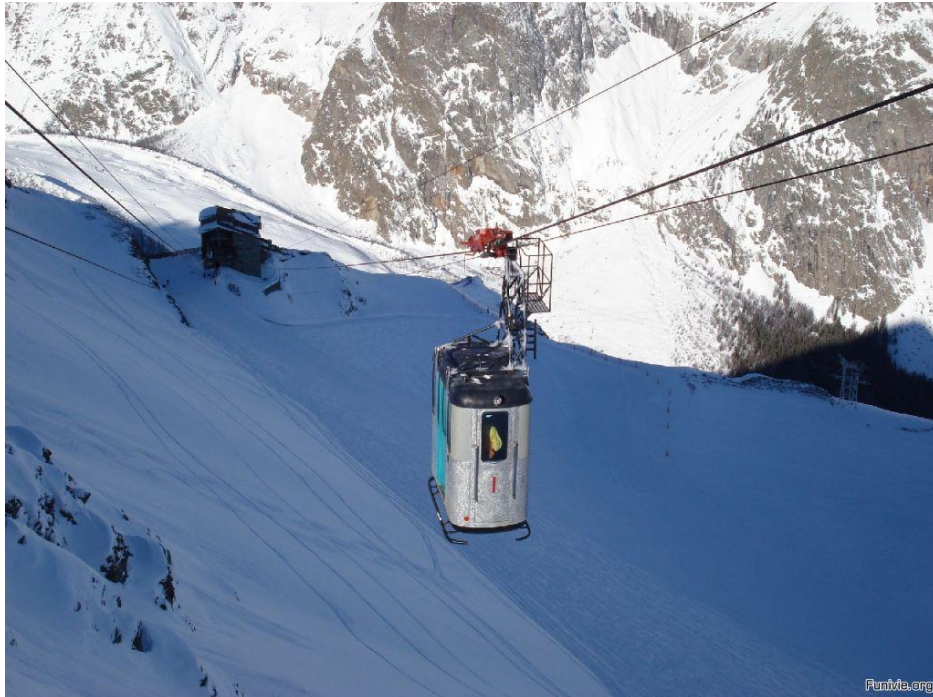
Foto n. 20a - Funivia Cresta di Youla - Cresta d'Arp (Valle D'Aosta) Ceretti 1963, (8 posti), 2 cabine, campata unica ( fonte internet )
